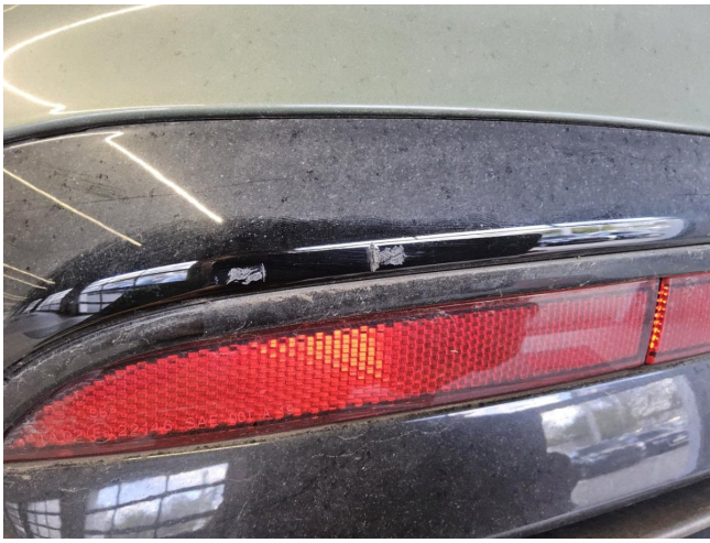
Blende Stoßfänger hinten links erneuern
