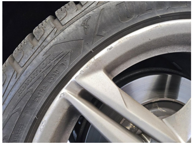
Felge (Winter-Radsatz) - Hinterachse rechts - Lackieren
