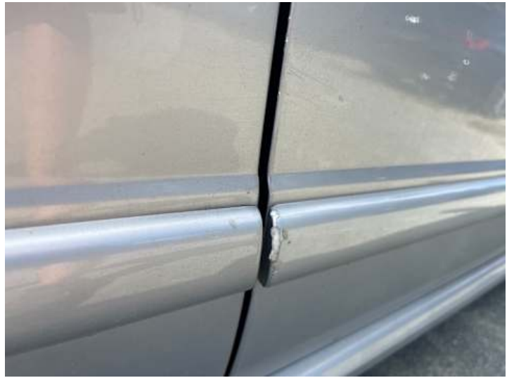
Beifahrer­tür (Kratzer, Lackscha­den)
