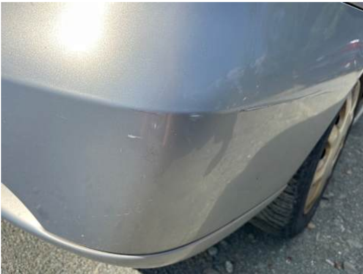
Stoß­stange hin­ten (Lackscha­den, Kratzer)
