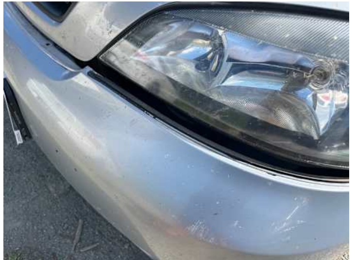
Stoßstange vorne (Riss/Bruch)
