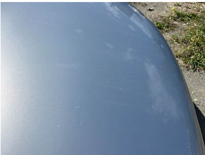
Motorhaube (Lackschaden, Kratzer)
