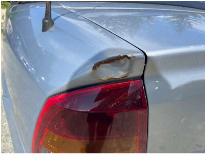
Seitenteil hinten links (Lackschaden, Kratzer, Rost, Verformung)
