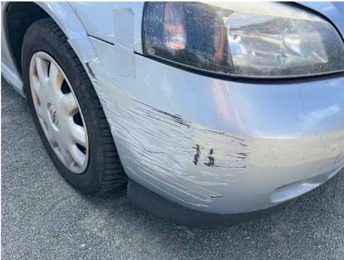
Stoßstange vorne (Lackschaden, Kratzer)
