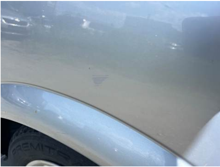
Seitenteil hinten links (Lackschaden, Kratzer)
