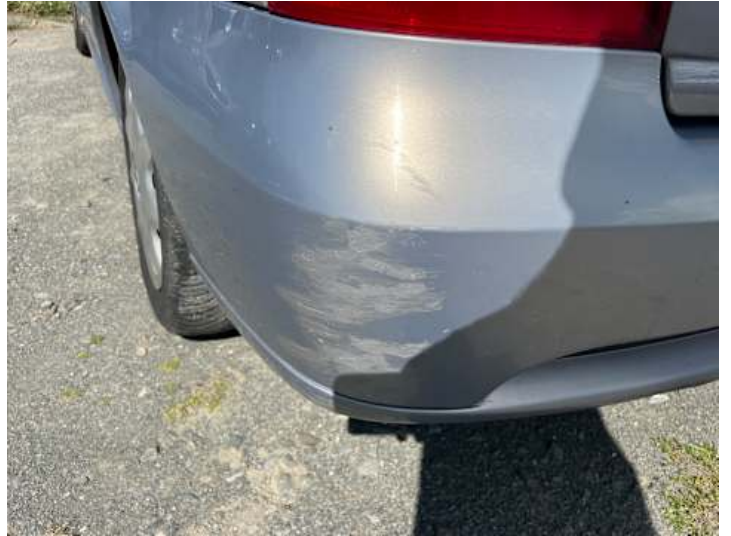
Stoß­stange hin­ten (Lackscha­den, Kratzer)
