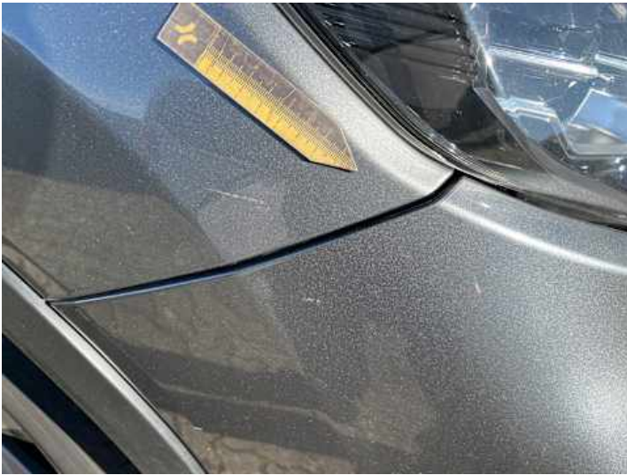
Stoßstange vorne (Spaltmaße ungenau)
