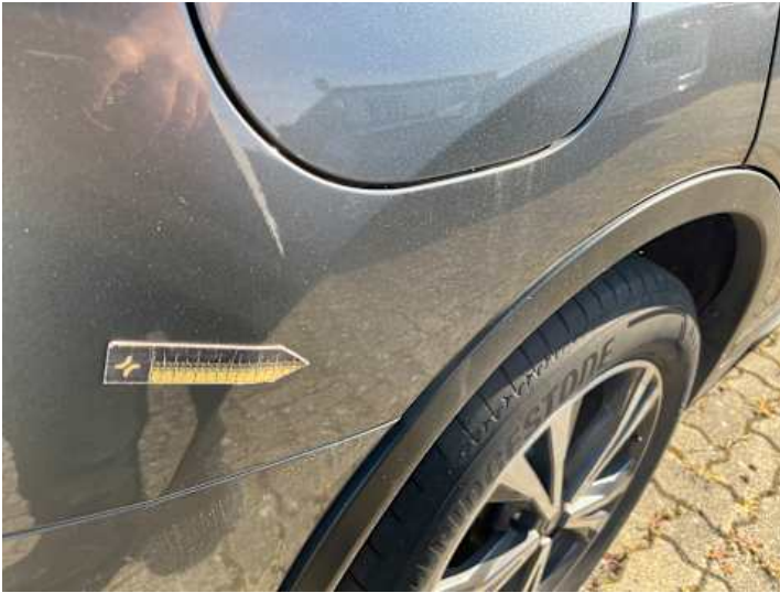
Seitenteil hinten rechts (Steinschlag)
