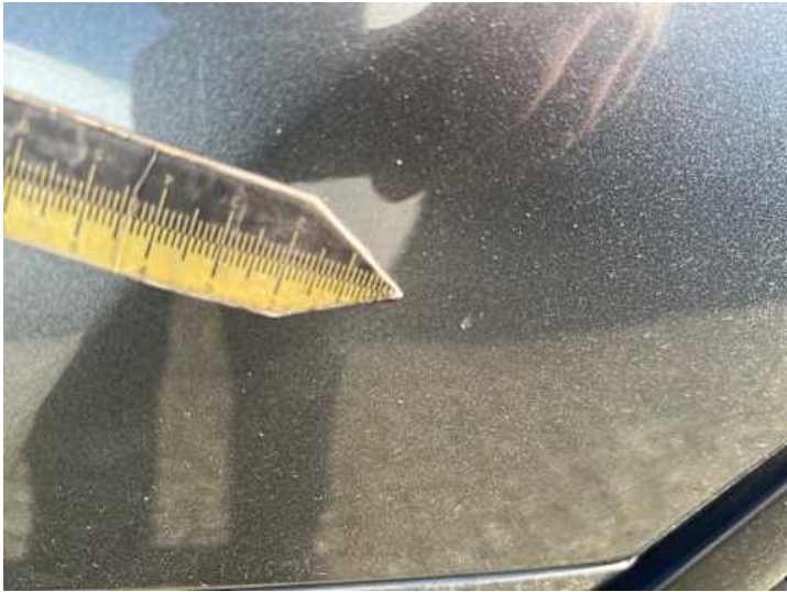
Seitenteil hinten rechts (Steinschlag)
