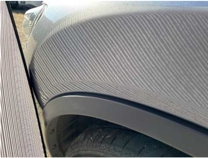
Kotflügel vorne links (Unsachgemäß instand gesetzt)
