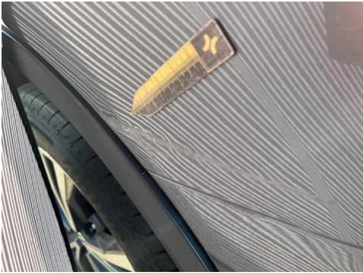
Seitenteil hinten links (Kratzer, Unsachgemäß instand gesetzt, Delle)
