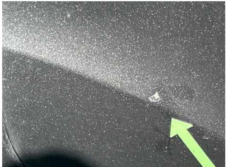
Türe hinten rechts (Kratzer)
