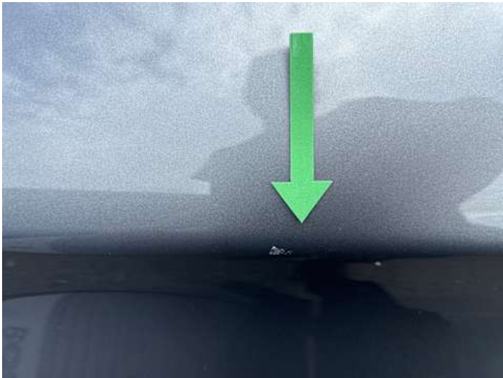
Türe hinten links (Lackschaden)
