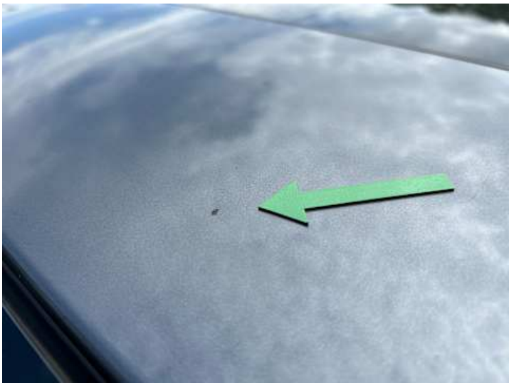
Dach (Lackschaden, Steinschlag)
