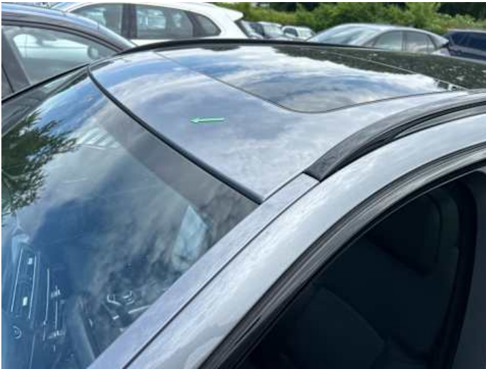
Dach (Lackschaden, Steinschlag)
