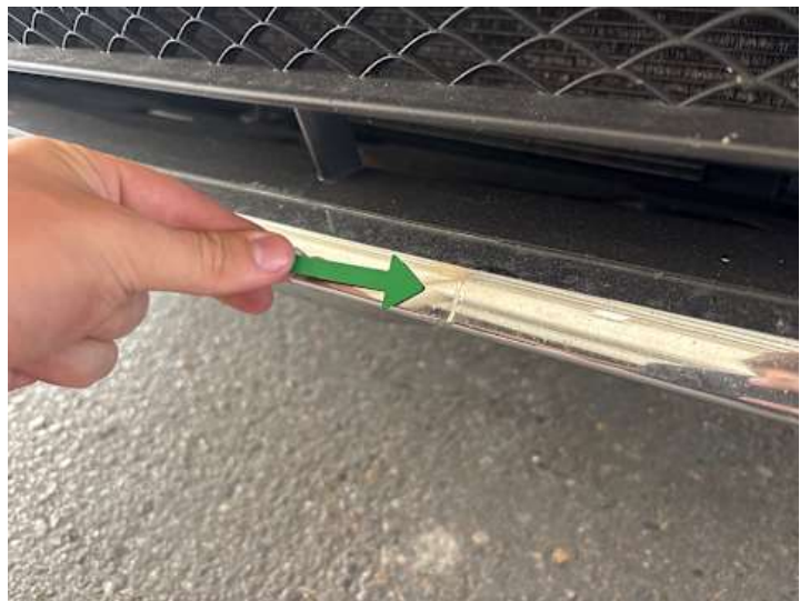
Stoßstange vorne (Verformung)
