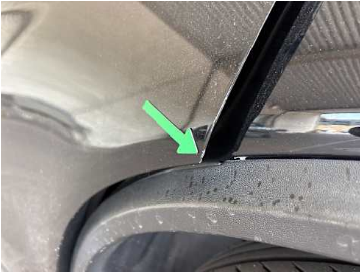
Türe hinten links (Lackschaden)
