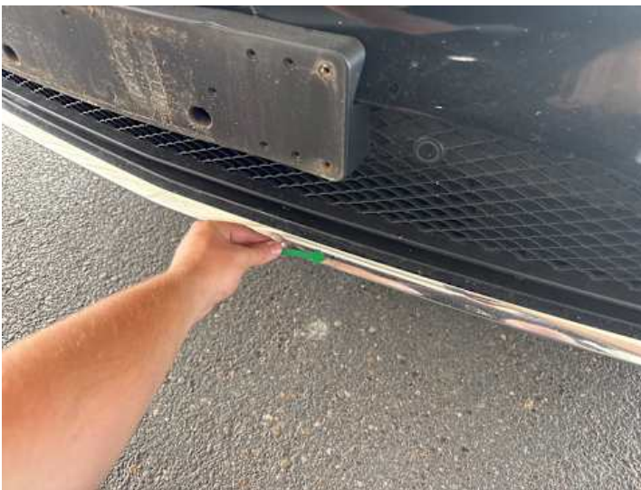
Stoßstange vorne (Verformung)
