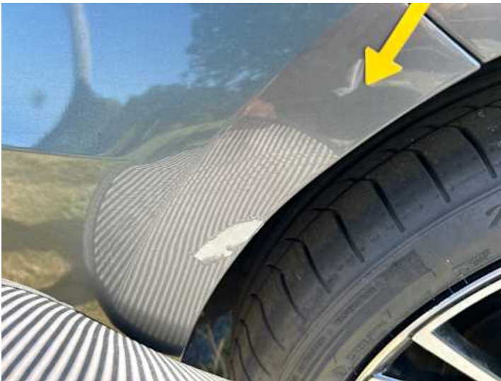
Stoßstange hinten (Kratzer, Verformung)
