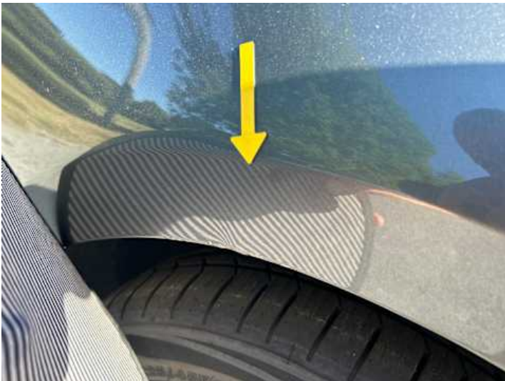
Kotflügel vorne rechts (Verformung, Kratzer)
