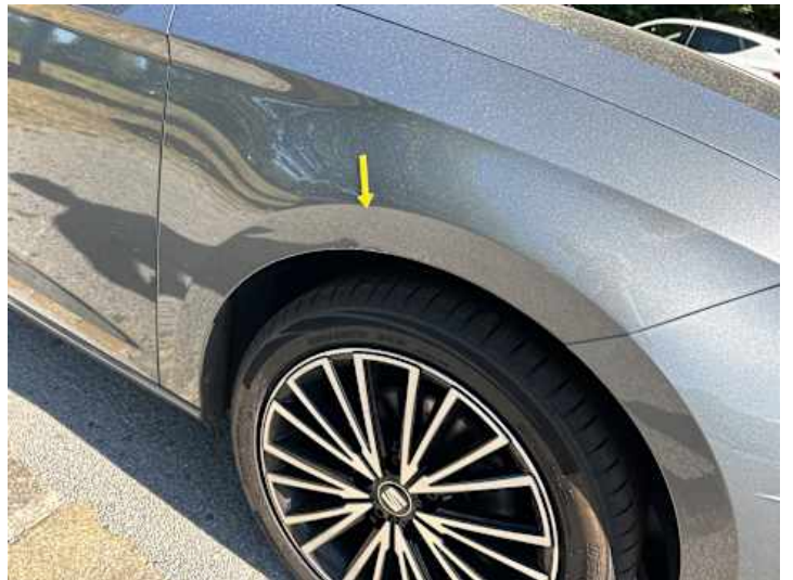
Kotflügel vorne rechts (Verformung, Kratzer)
