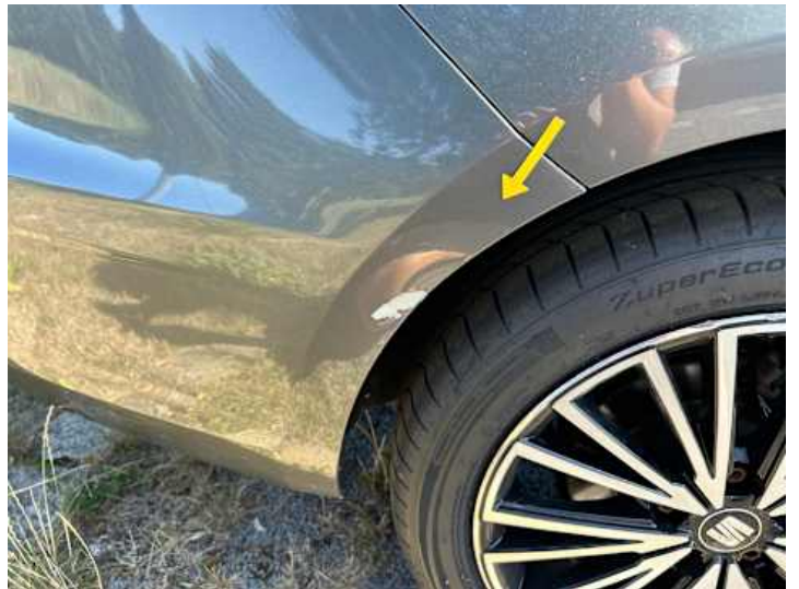
Stoßstange hinten (Kratzer, Verformung)
