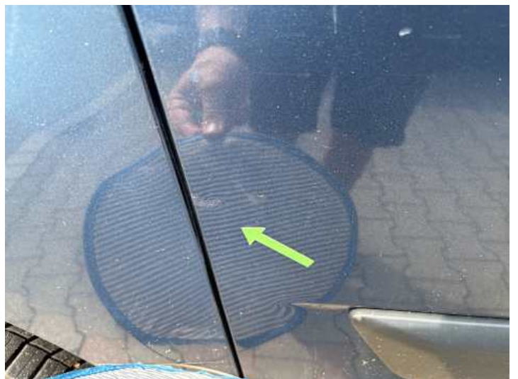
Türe hinten rechts (Kratzer, Lackschaden, Delle)
