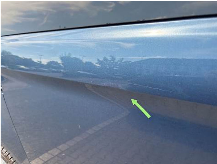
Türe hinten rechts (Kratzer, Lackschaden, Delle)
