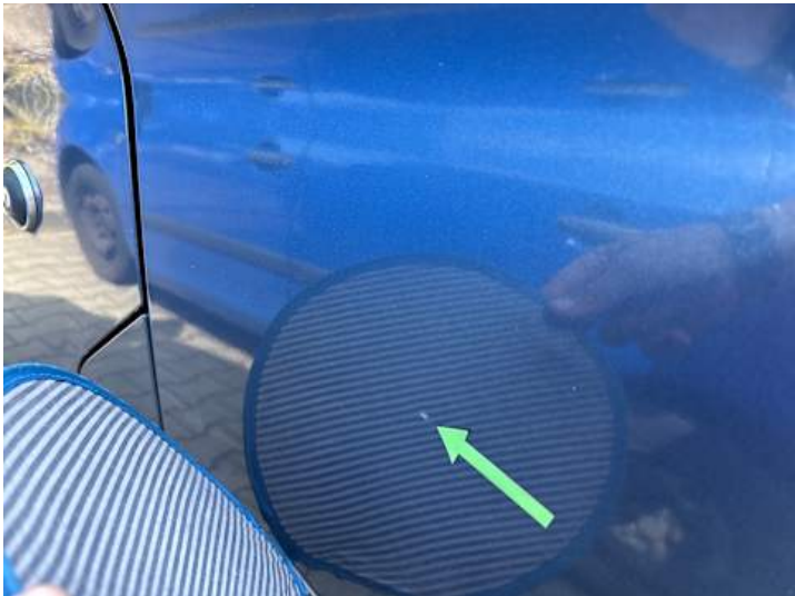
Seitenteil hinten links (Delle, Kratzer)
