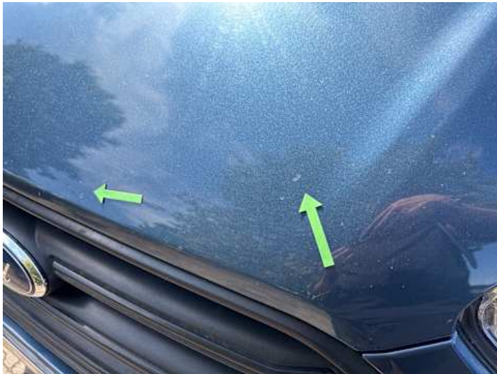
Motorhaube (Steinschlag, Lackschaden)
