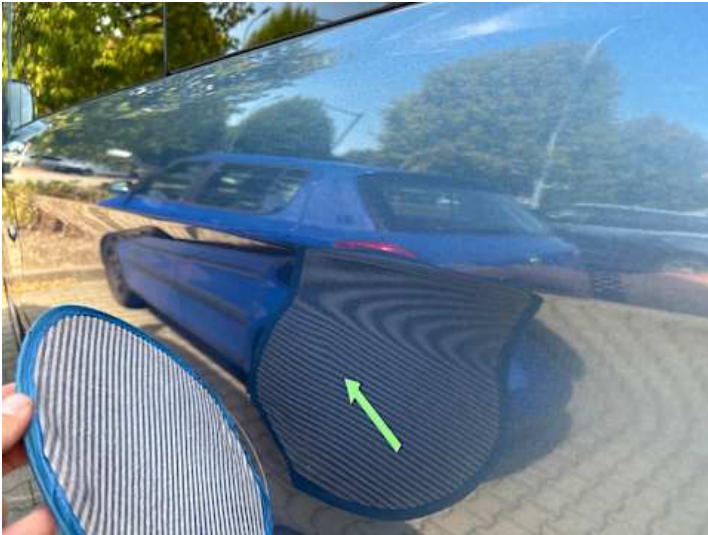
Seitenteil hinten links (Delle, Kratzer)
