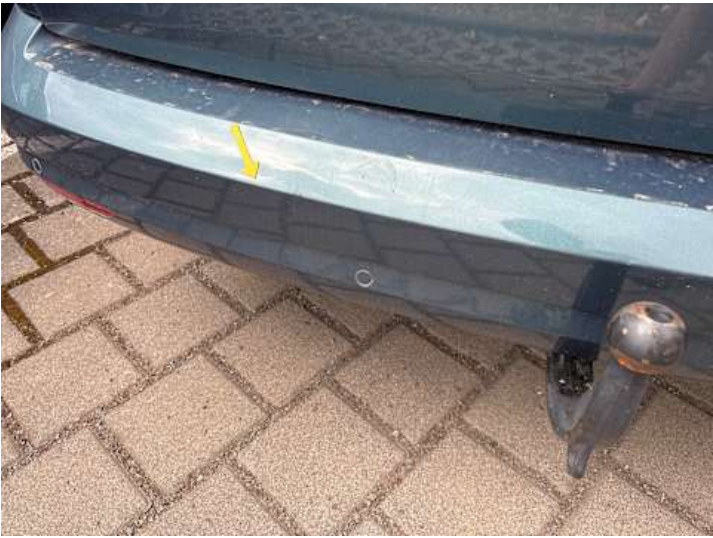
Stoßstange hinten (Lackschaden, Verformung)
