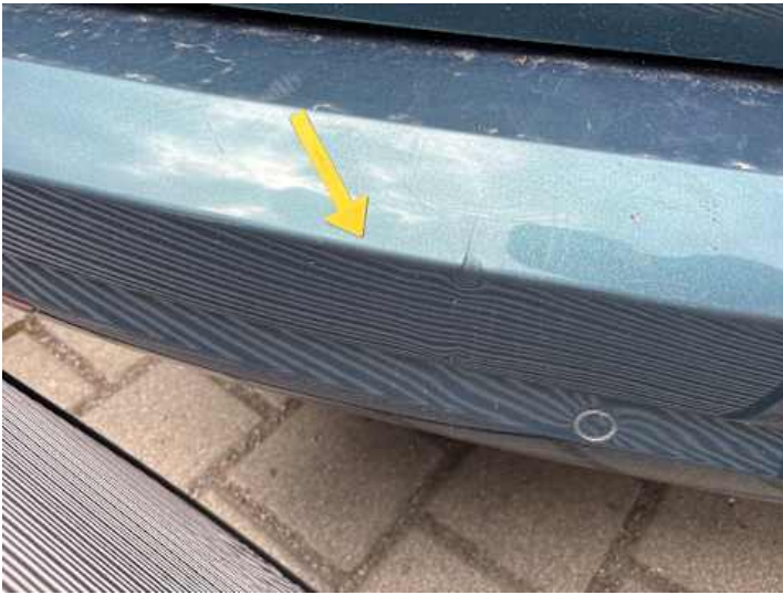
Stoßstange hinten (Lackschaden, Verformung)
