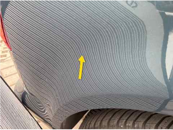
Seitenteil hinten rechts (Delle)
