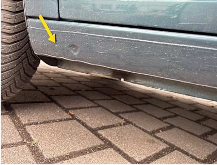
Schweller links (Verformung)
