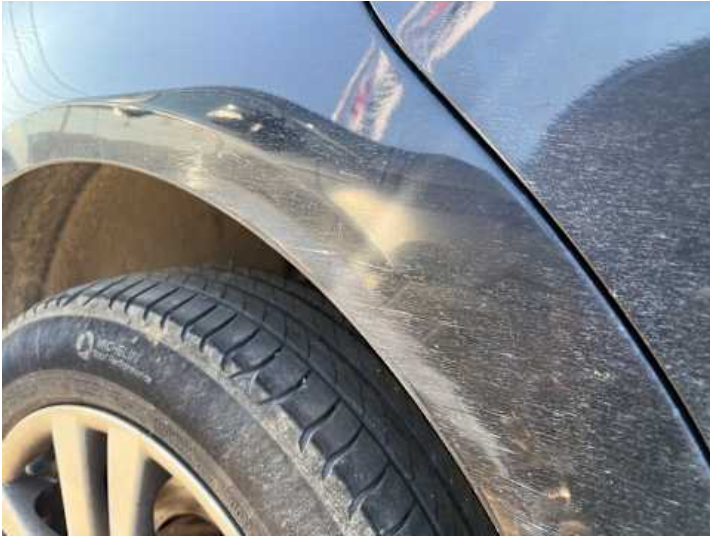
Seitenteil hinten rechts (Lackschaden)
