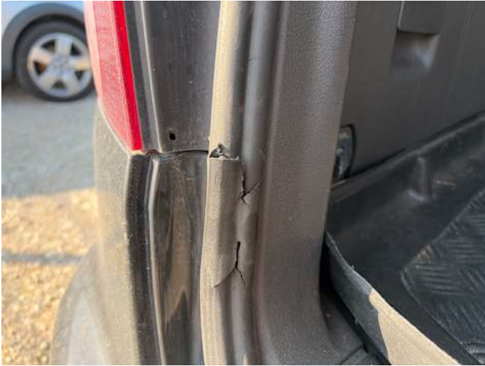
Innenraum (Anderer Schaden): Dichtung beschädigt
