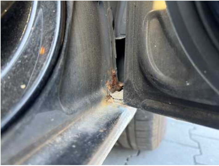
Schweller rechts (Rost)
