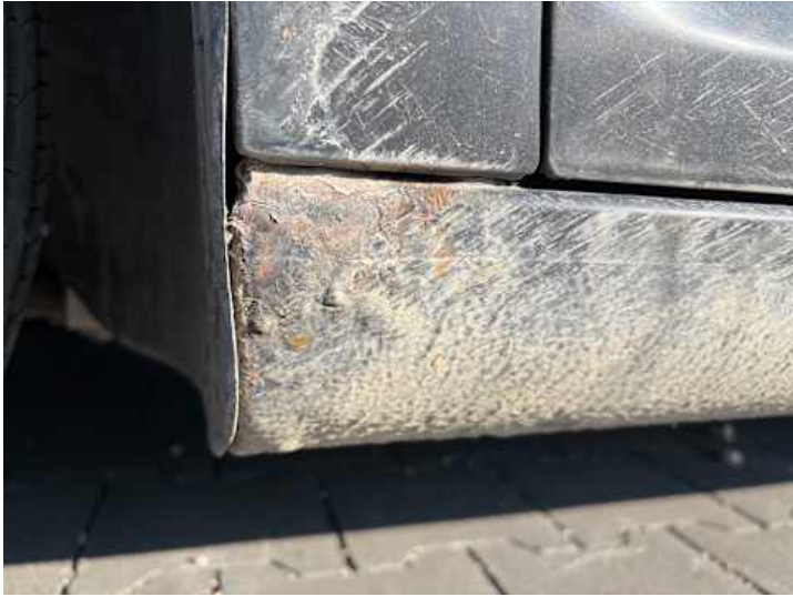
Schweller links (Rost)
