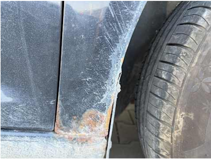
Kotflügel vorne rechts (Rost)
