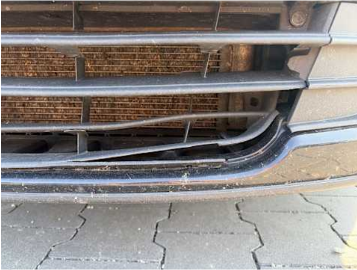
Stoßstange vorne (Riss/Bruch)
