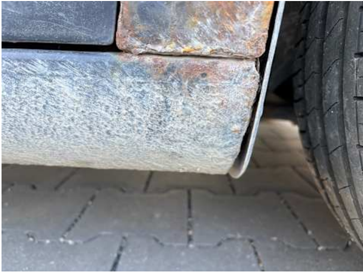
Schweller rechts (Rost)
