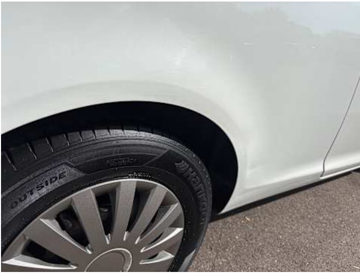
Seitenteil hinten rechts (Lackschaden, Verformung)
