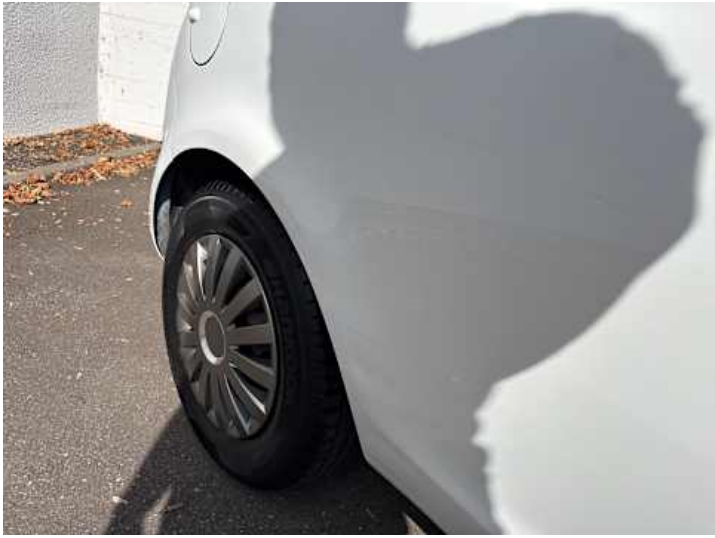
Seitenteil hinten rechts (Lackschaden, Verformung)
