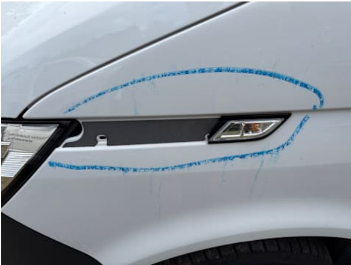
Kotflügel vorne links (Riss/Bruch)
