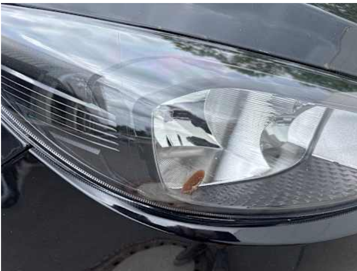
Scheinwerfer (rechts) (Riss/Bruch, Kratzer)
