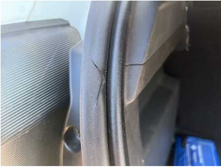
Heckklappe (Anderer Schaden): Dichtung defekt
