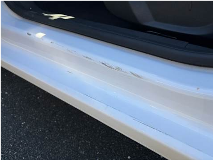
Schweller links (Kratzer)
