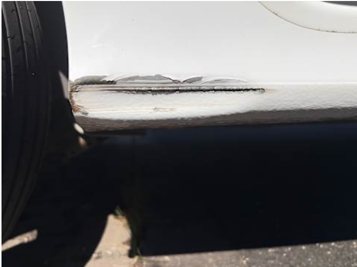
Schweller rechts (Verformung, Lackschaden)
