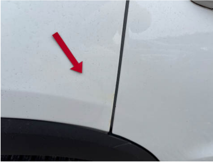
Seitenteil hinten rechts (Lackschaden)
