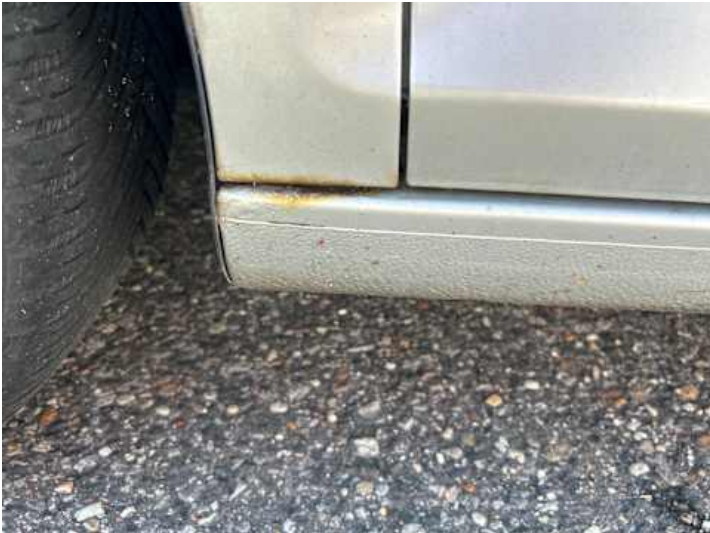
Schweller links (Rost)
