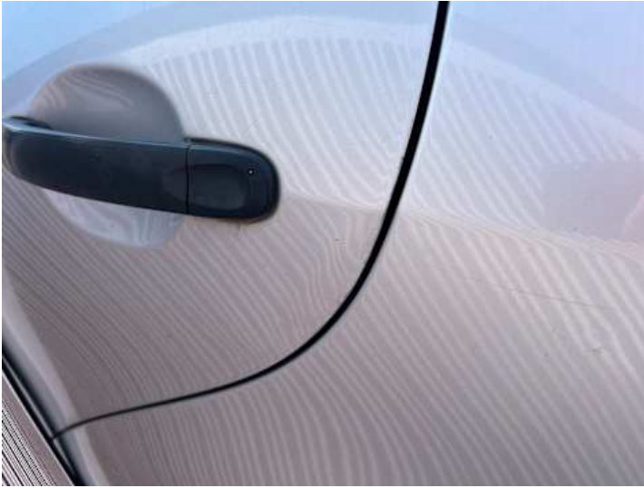
Türe hinten links (Verformung)
