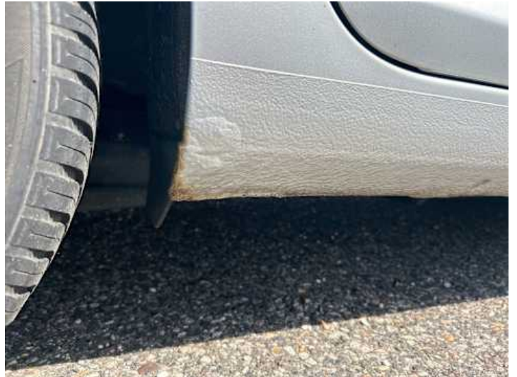
Schweller rechts (Rost)
