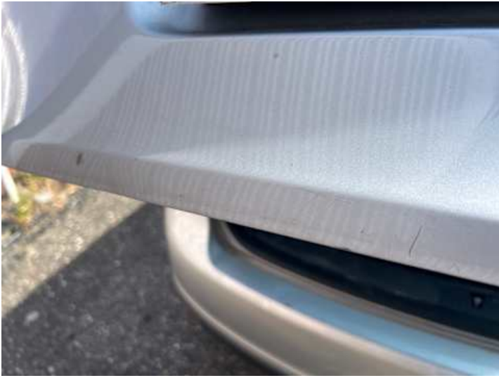
Heckklappe (Verformung, Kratzer)
