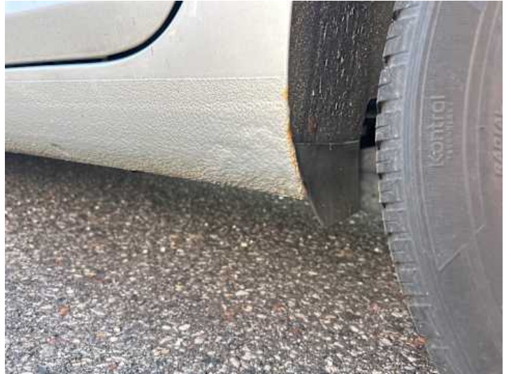
Schweller links (Rost, Verformung)
