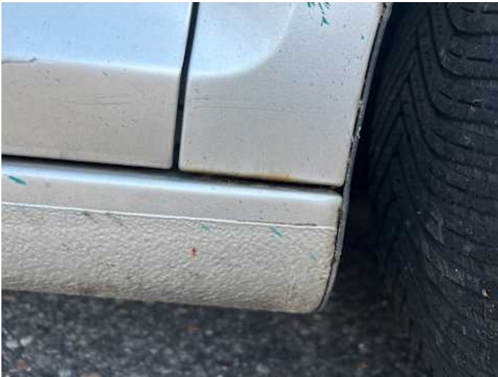
Kotflügel vorne rechts (Rost)
