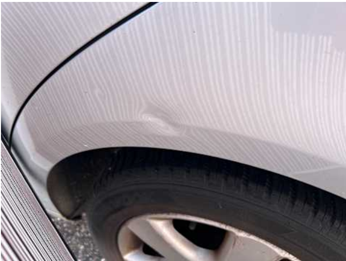
Seitenteil hinten links (Verformung)
