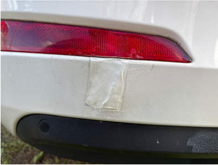
Stoßstange hinten (Riss/Bruch, Unsachgemäß instand gesetzt)
