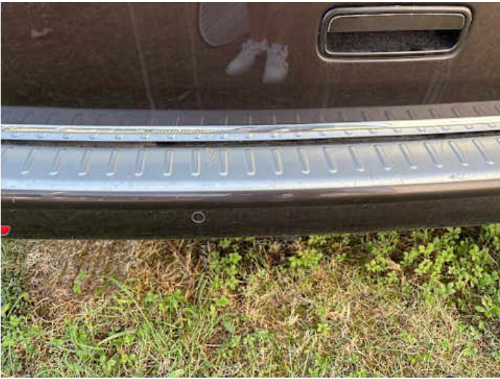
Stoßstange hinten (Kratzer, Lackschaden)
