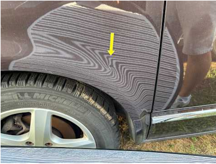
Seitenteil hinten rechts (Delle)
