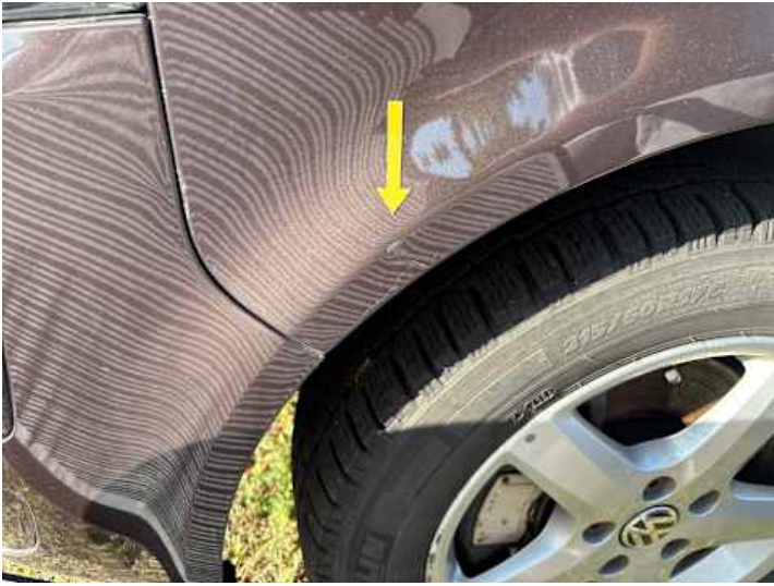
Kotflügel vorne links (Delle, Lackschaden)
