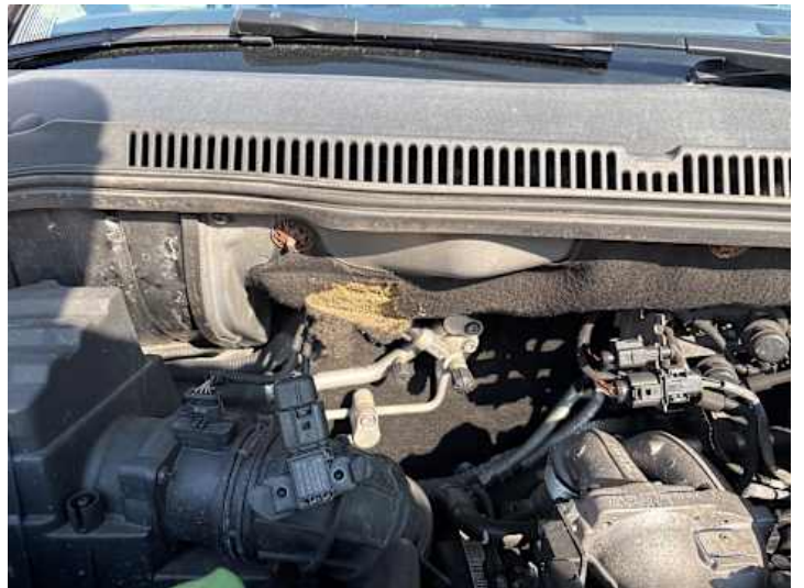
Motorhaube (Anderer Schaden): Marderspuren
