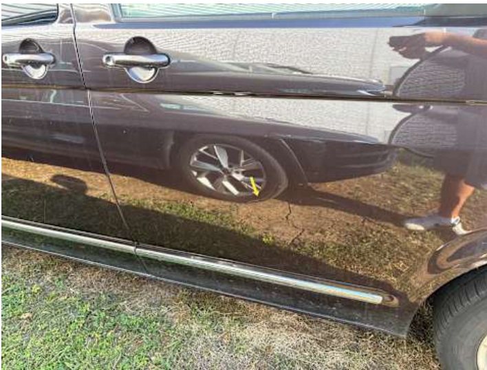
Beifahrertür (Lackschaden, Kratzer, Delle)
