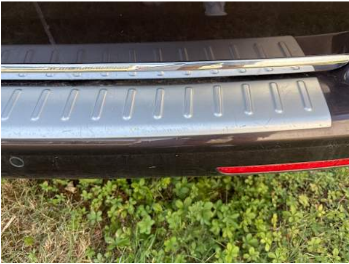
Stoßstange hinten (Kratzer, Lackschaden)
