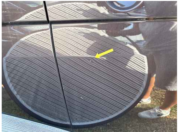
Beifahrtür (Lackschaden, Kratzer, Delle)
