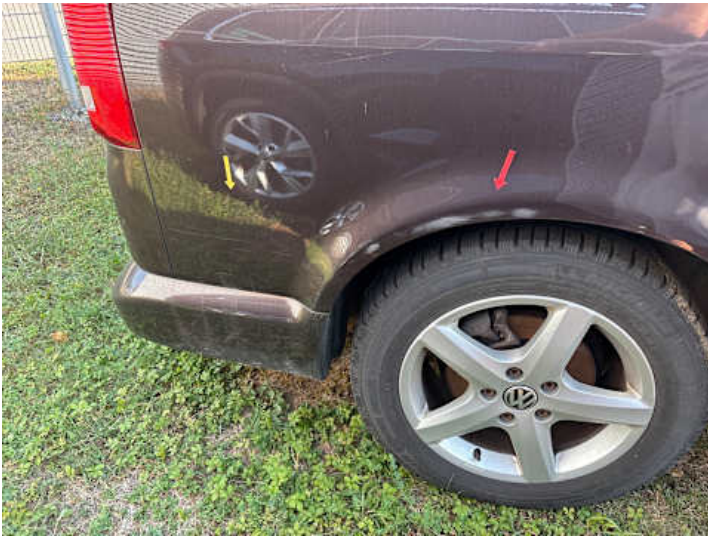
Seitenteil hinten rechts (Lackschaden)
