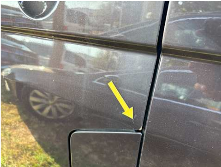
Fahrtür (Lackschaden, Rost)
