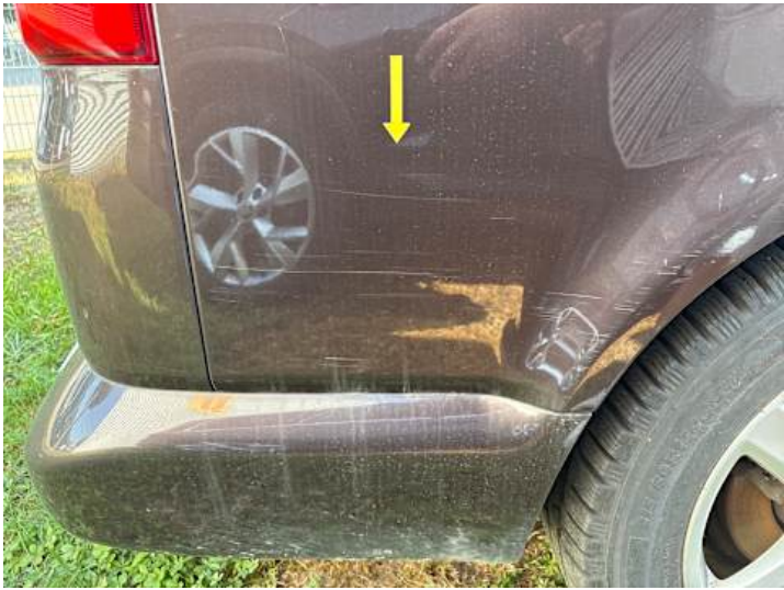
Seitenteil hinten rechts (Lackschaden)
