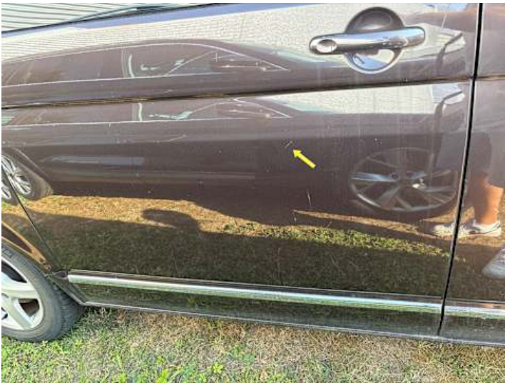
Türe hinten rechts (Kratzer, Lackschaden)
