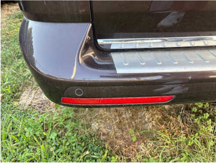
Stoßstange hinten (Kratzer, Lackschaden)
