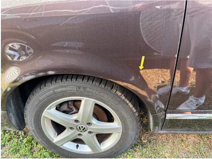
Seitenteil hinten rechts (Delle)
