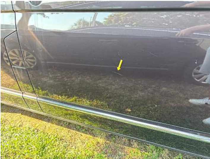
Türe hinten links (Kratzer)
