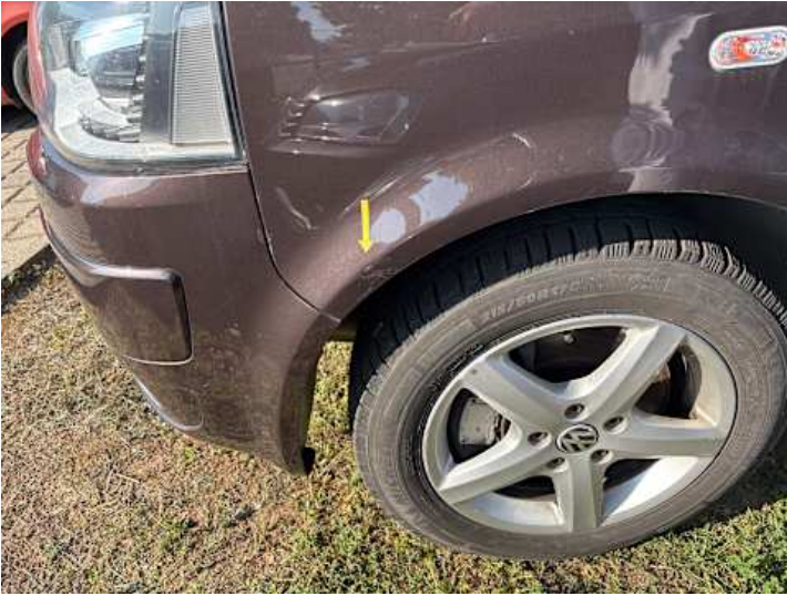
Kotflügel vorne links (Delle, Lackschaden)
