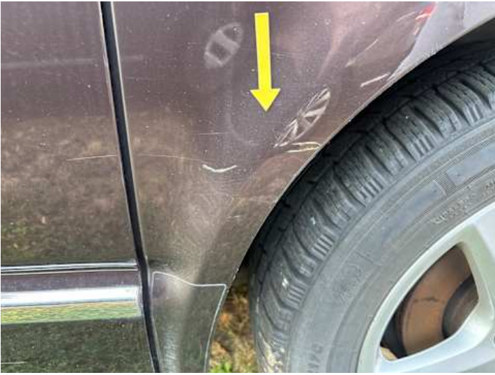
Seitenteil hinten links (Kratzer)
