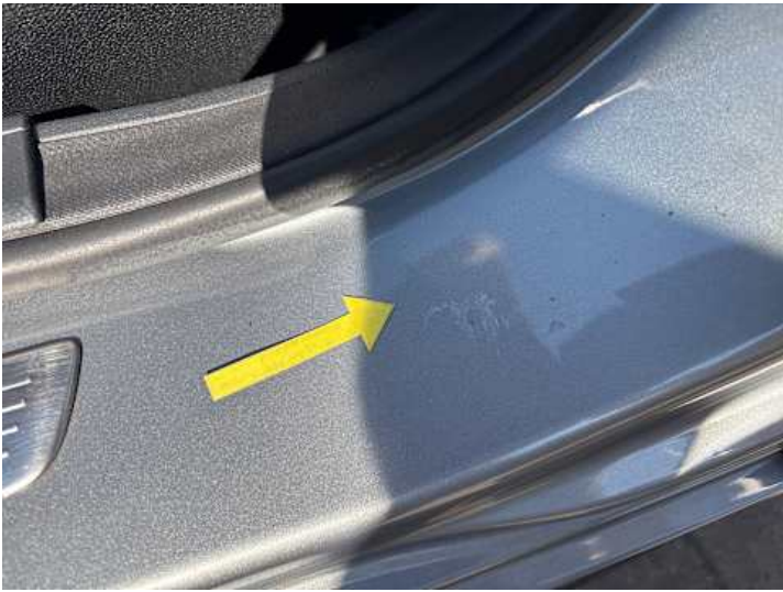
Schweller links (Kratzer, Unsachgemäß instand gesetzt)
