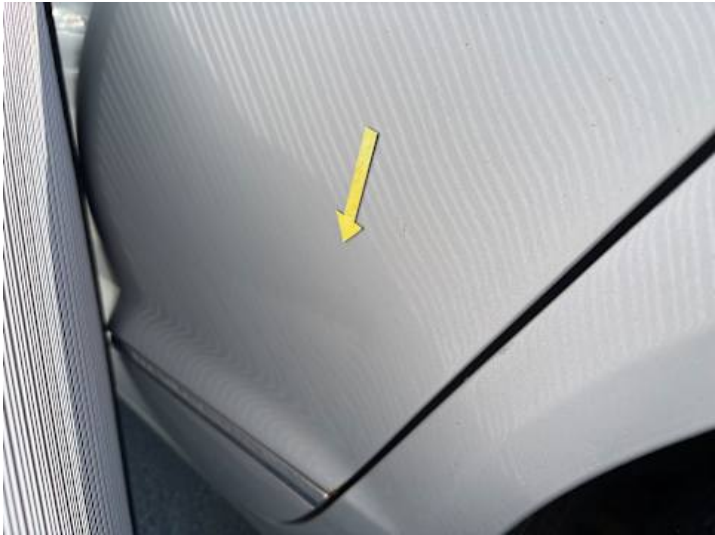
Türe hinten links (Delle, Verformung)
