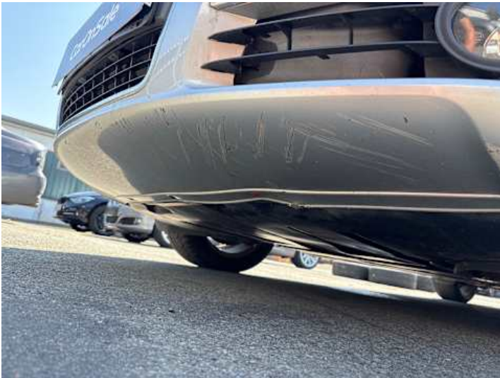
Stoßstange vorne (Kratzer, Lackschaden)
