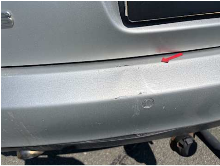
Stoßstange hinten (Verformung, Riss/Bruch, Lackschaden)
