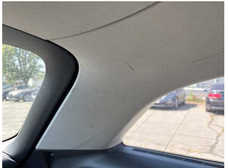
Innenraum (Kratzer, Verschmutzung)
