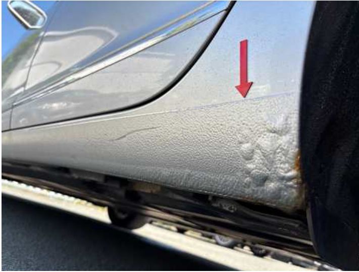
Schweller links (Rost)
