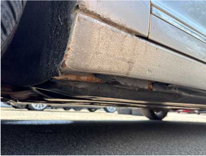
Schweller links (Rost)
