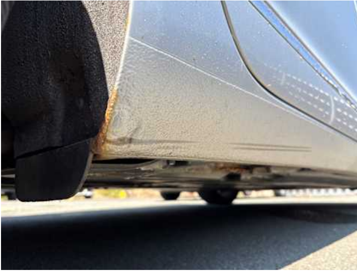
Türe hinten rechts (Rost)
