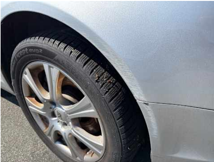
Kotflügel vorne rechts (Kratzer, Lackschaden)
