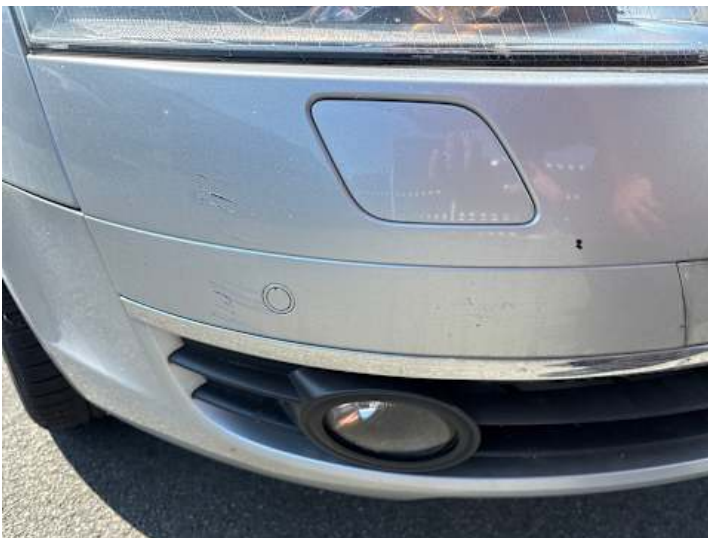
Stoßstange vorne (Kratzer, Lackschaden)
