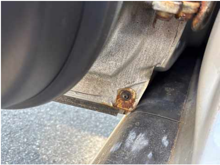
Türe hinten links (Rost)
