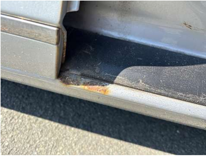
Schweller rechts (Rost)
