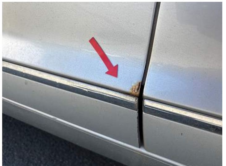
Fahrtür (Rost, Lackschaden)
