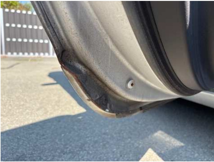
Türe hinten links (Rost)
