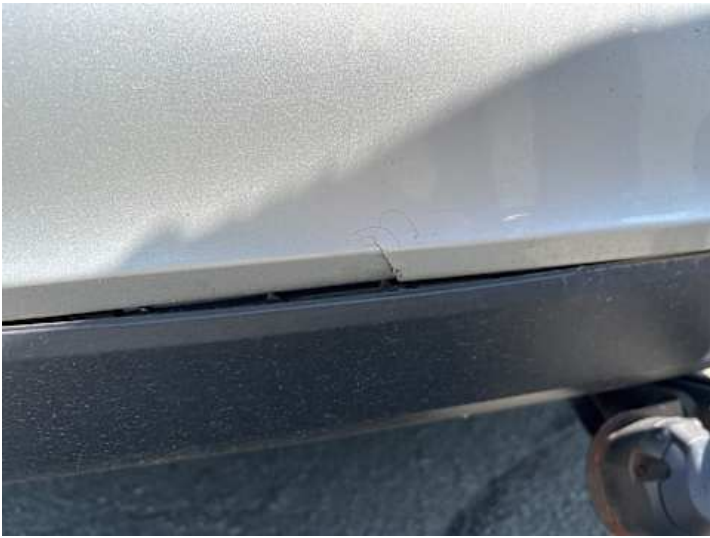
Stoßstange hinten (Verformung, Riss/Bruch, Lackschaden)
