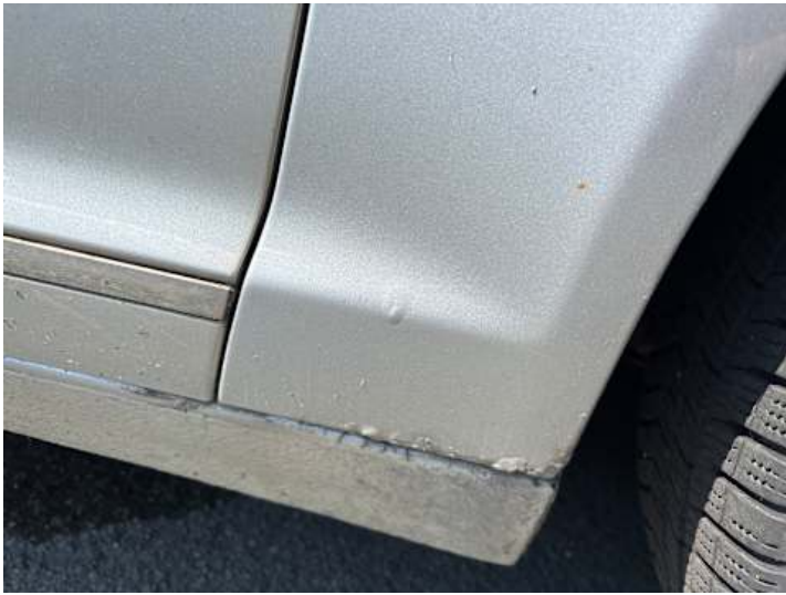
Kotflügel vorne rechts (Rost)
