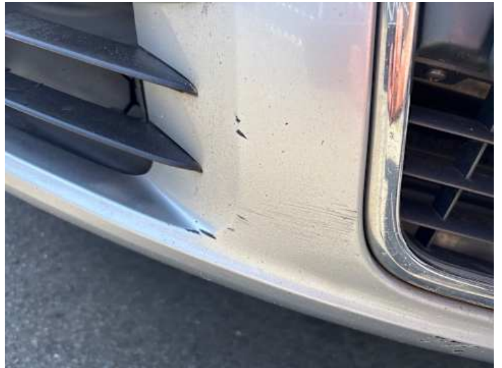
Stoßstange vorne (Kratzer, Lackschaden)
