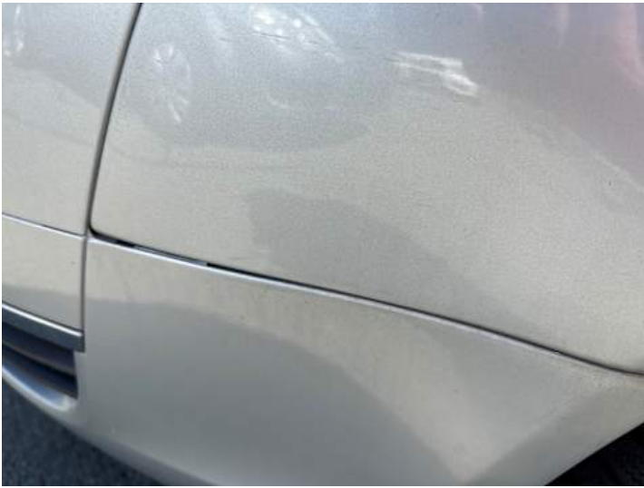
Kotflügel vorne links (Spaltmaße ungenau)
