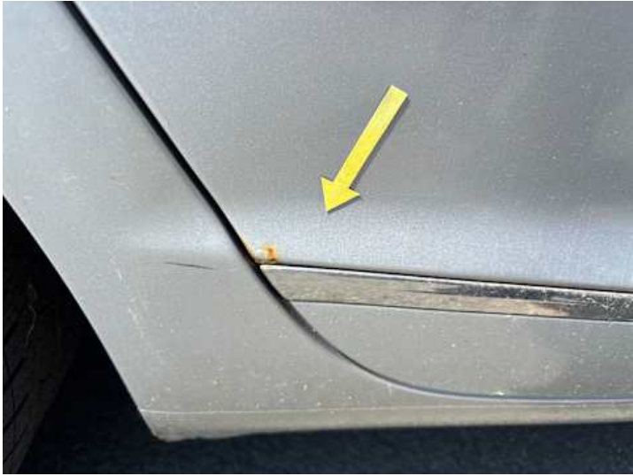
Türe hinten rechts (Rost)
