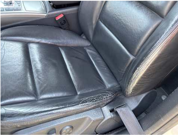
Innenraum (Verschleiß, Riss/Bruch)
