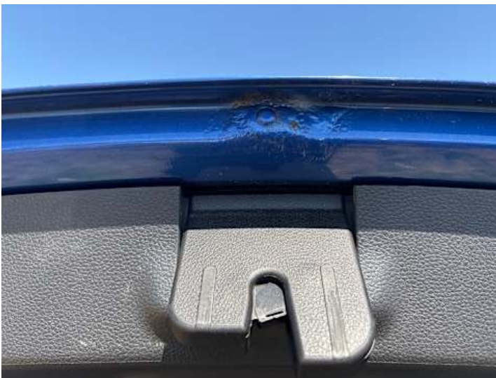
Heckklappe (Rost, Lackschaden)
