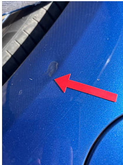
Seitenteil hinten rechts (Delle, Lackschaden)
