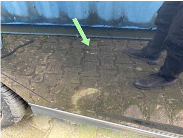
Türe hinten rechts (Kratzer, Riss/Bruch)
