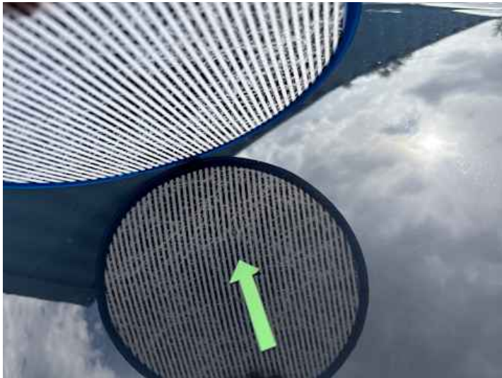
Motorhaube (Delle, Steinschlag)
