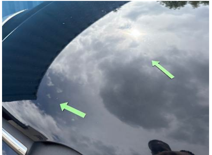
Motorhaube (Delle, Steinschlag)
