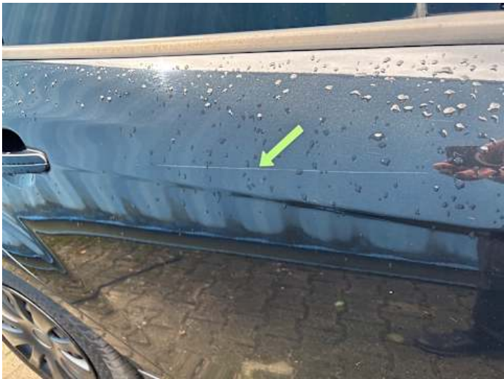
Türe hinten rechts (Kratzer, Riss/Bruch)
