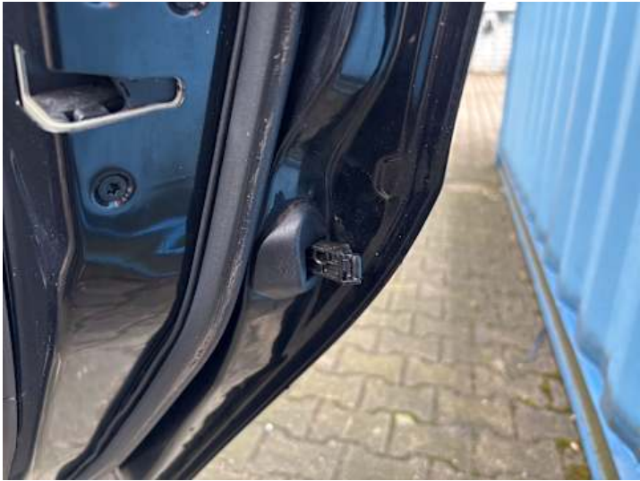
Türe hinten rechts (Kratzer, Riss/Bruch)
