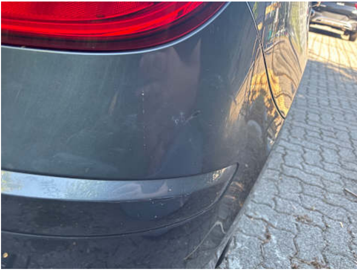
Stoßstange hinten (Lackschaden, Spaltmaße ungenau)
