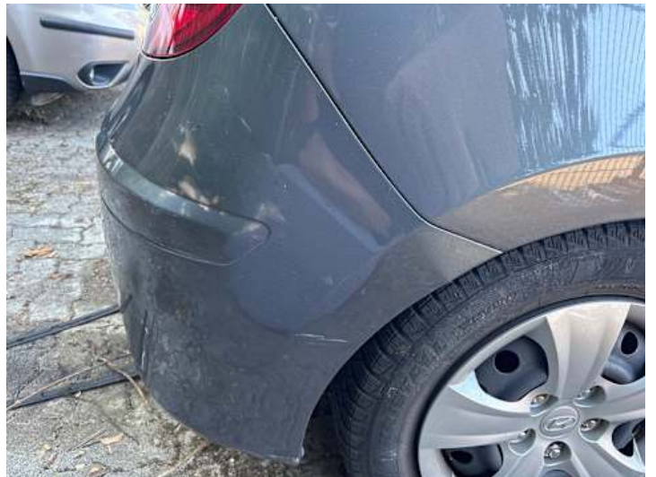
Stoßstange hinten (Lackschaden, Spaltmaße ungenau)
