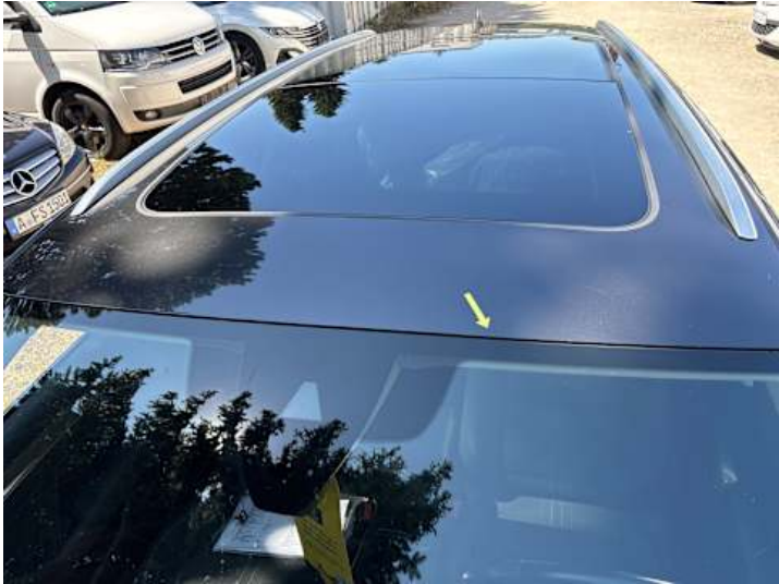
Dach (Lackschaden, Steinschlag)
