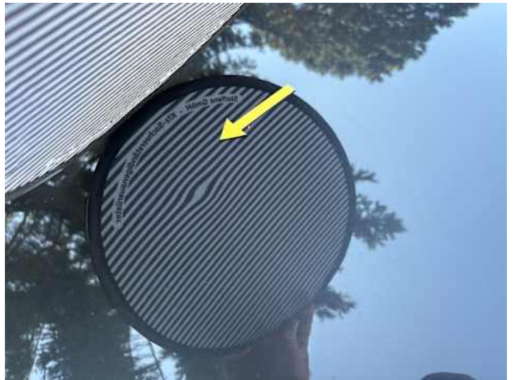
Motorhaube (Steinschlag, Delle)
