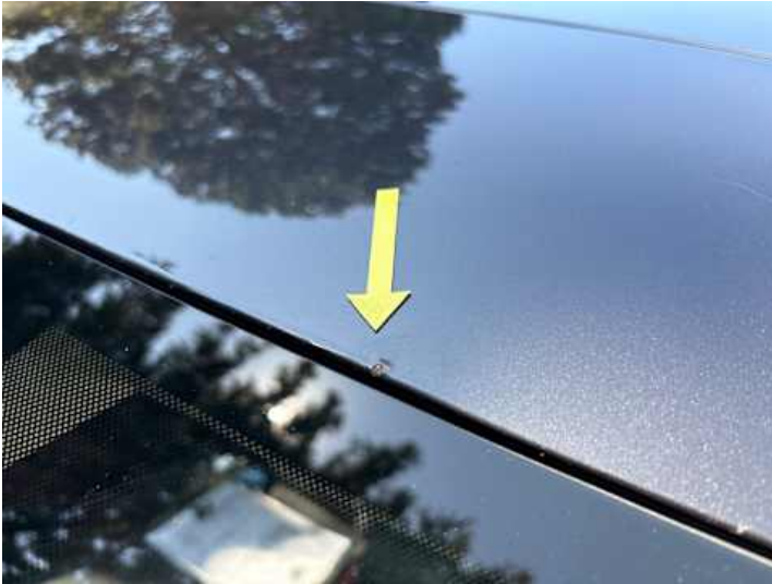
Dach (Lackschaden, Steinschlag)
