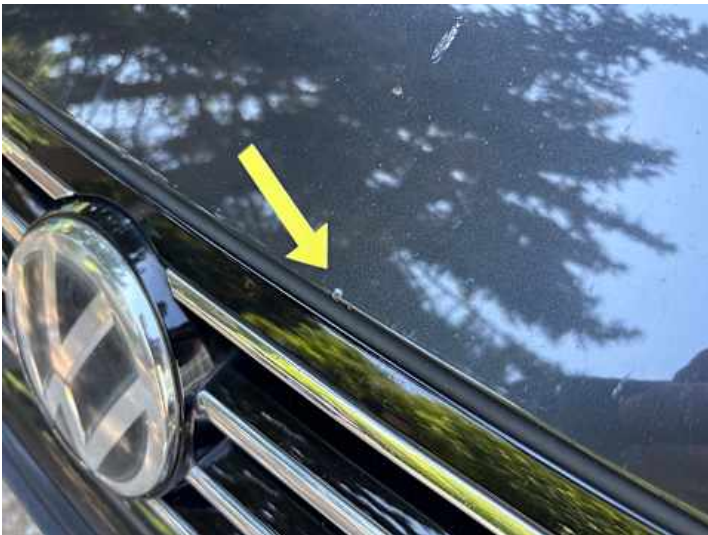
Motorhaube (Steinschlag, Delle)
