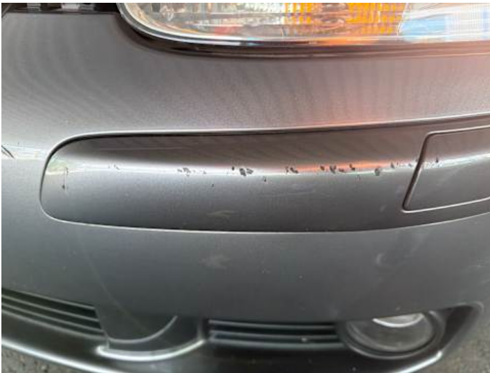
Stoßstange vorne (Kratzer, Lackschaden)
