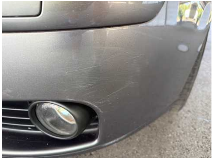
Stoßstange vorne (Kratzer, Lackschaden)
