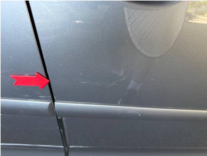
Beifahrtür (Kratzer, Lackschaden, Delle)
