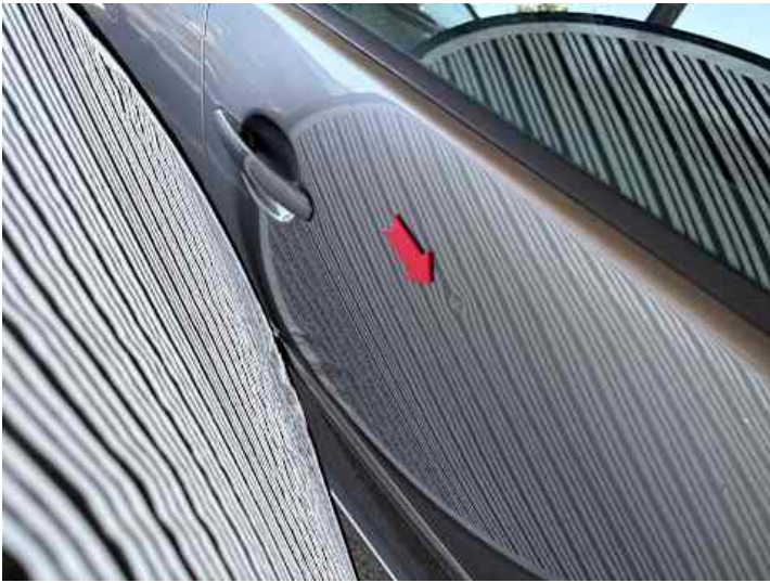
Beifahrertür (Kratzer, Lackschaden, Delle)
