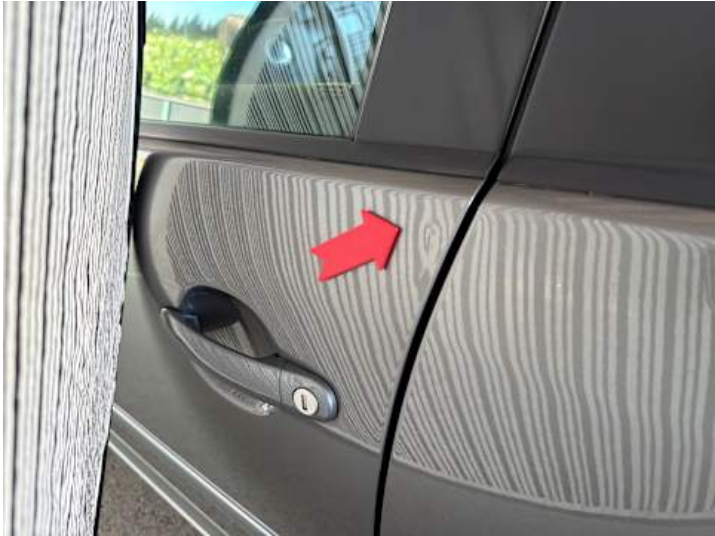
Fahrtür (Kratzer, Delle)
