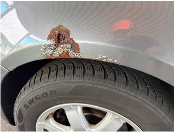
Kotflügel vorne links (Rost)
