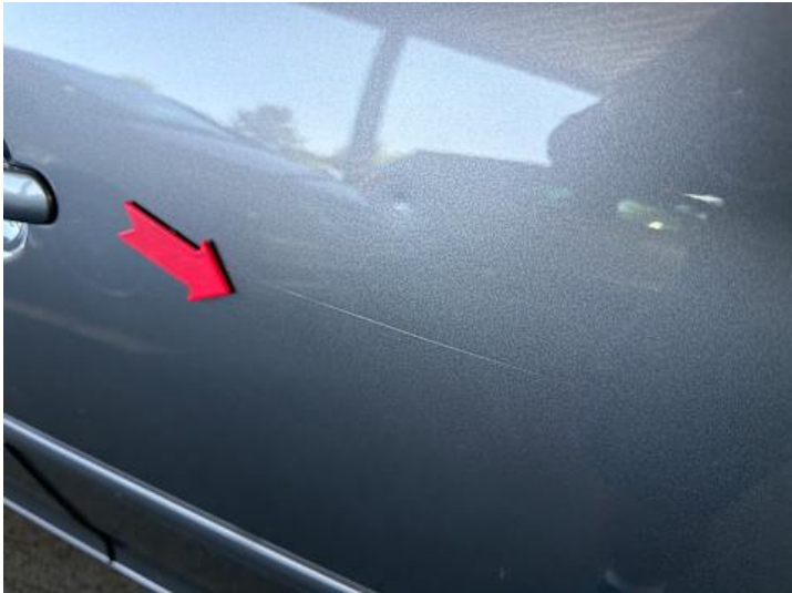
Beifahrtür (Kratzer, Lackschaden, Delle)
