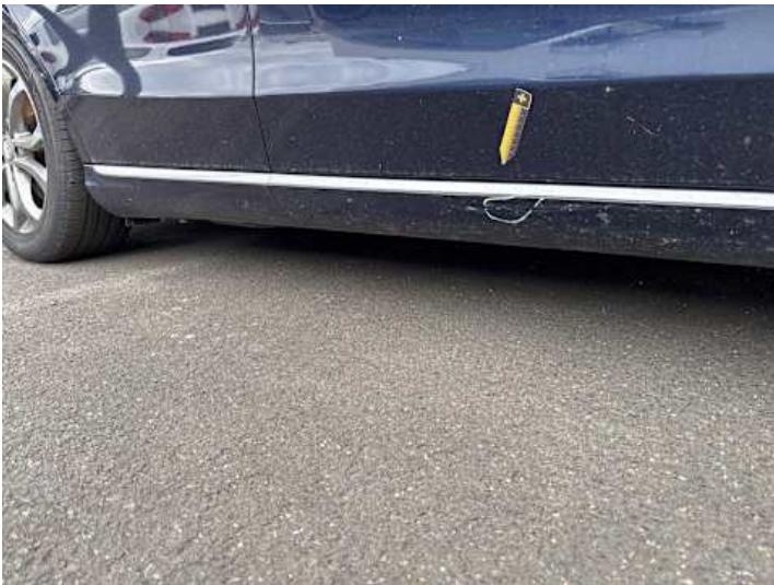
Schweller rechts (Verformung)
