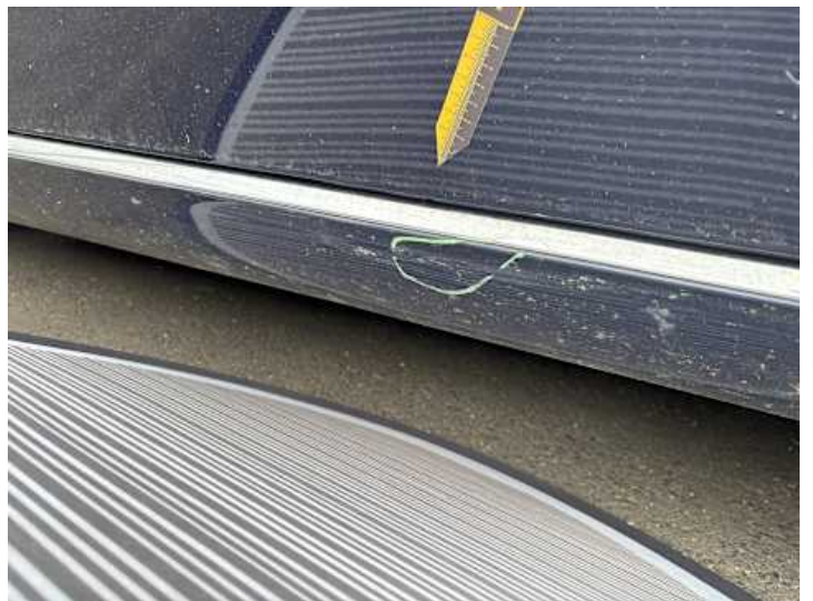
Schweller rechts (Verformung)
