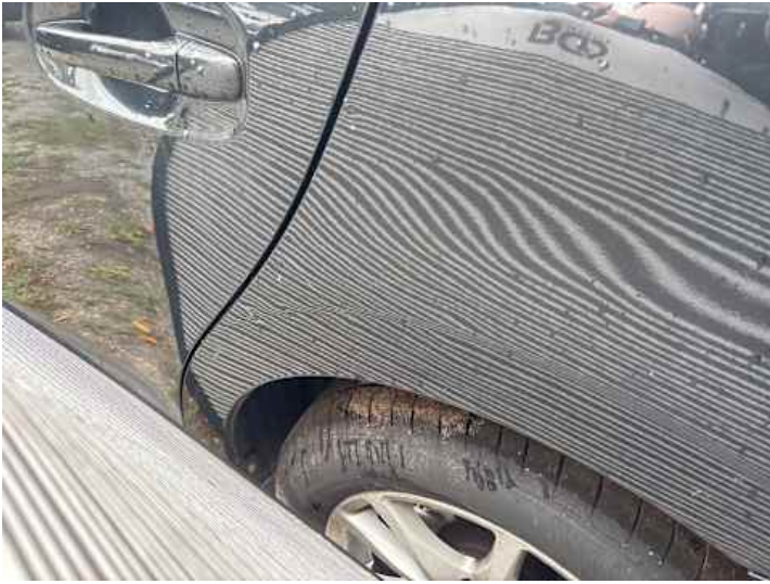
Seitenteil hinten links (Verformung)
