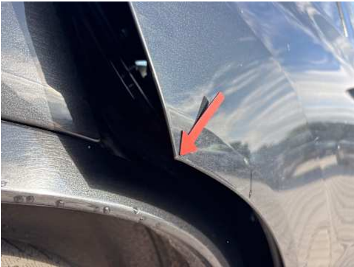
Türe hinten rechts (Delle)
