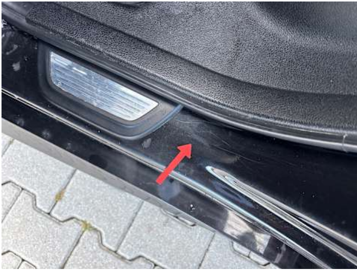
Schweller links (Kratzer)
