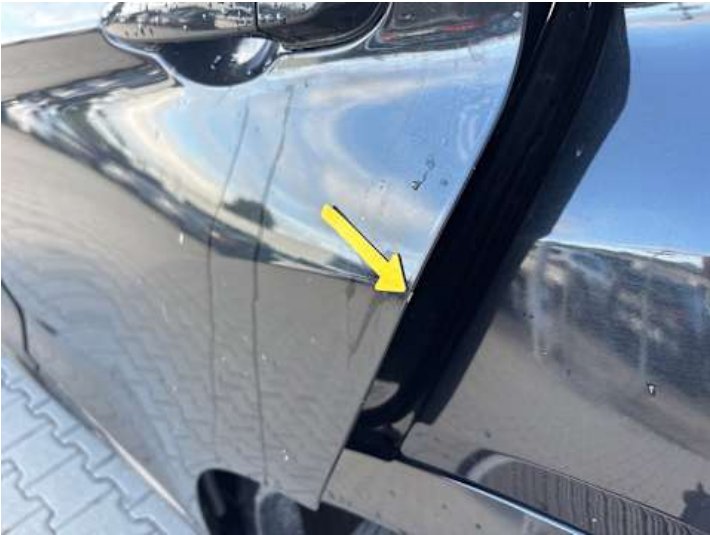
Türe hinten links (Lackschaden)
