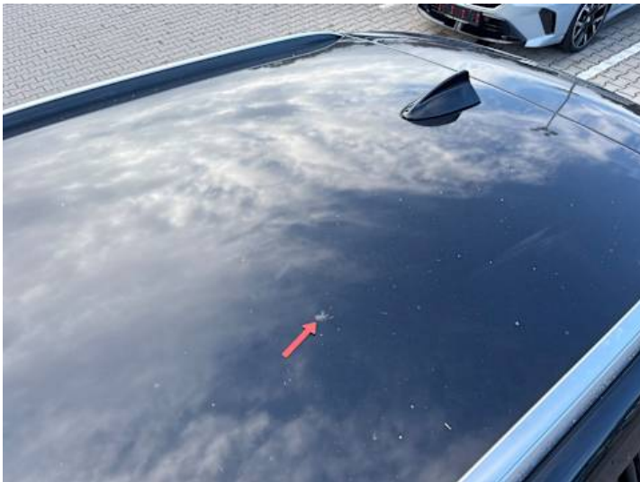
Dach (Lackschaden, Rost)
