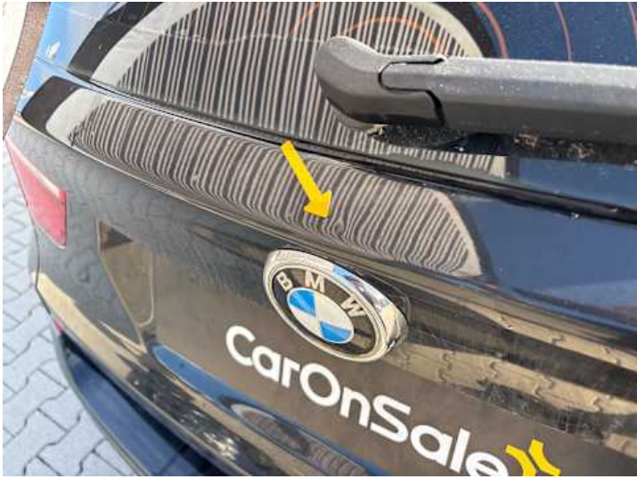
Heckklappe (Delle, Kratzer)
