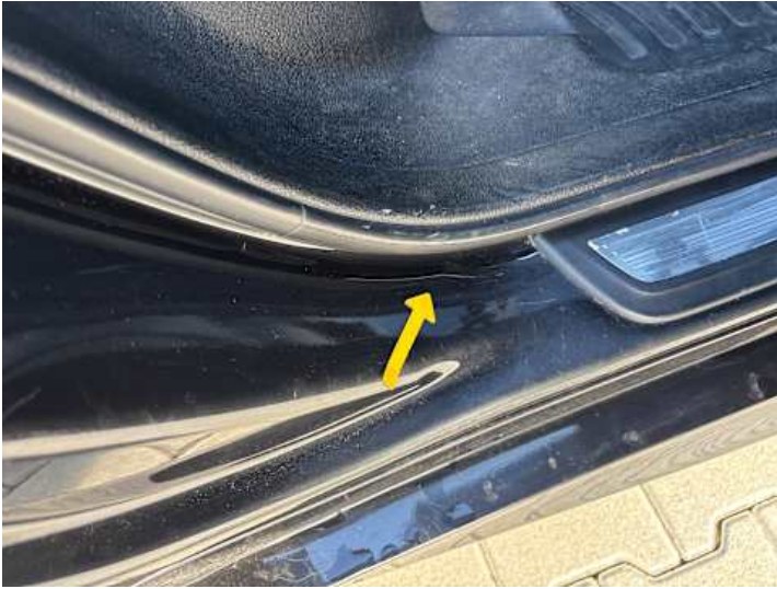
Schweller rechts (Kratzer)
