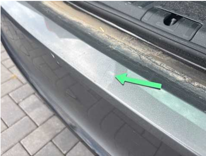
Stoßstange hinten (Kratzer)
