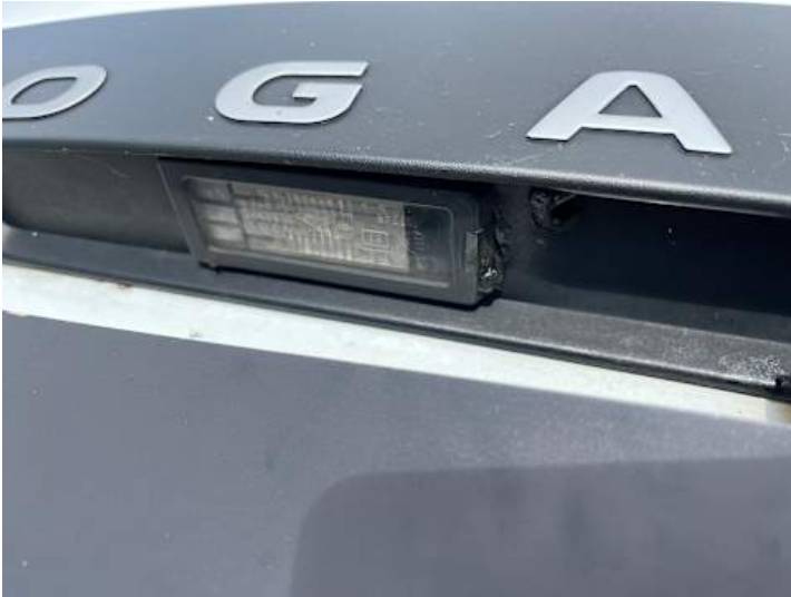
Heckklappe (Anderer Schaden): Kennzeichenleuchte geklebt
