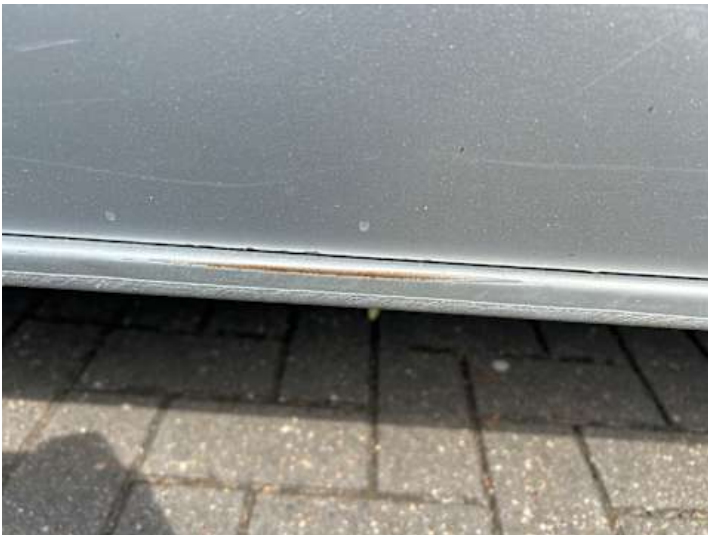
Schweller links (Rost, Lackschaden)
