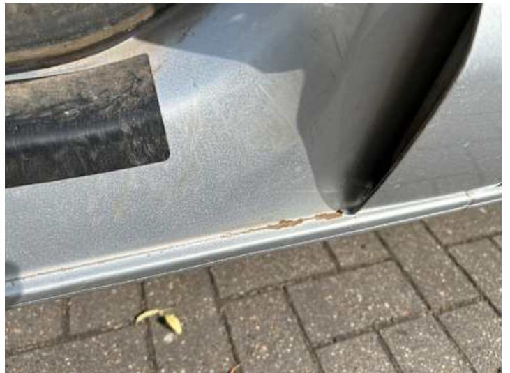
Schweller links (Rost, Lackschaden)
