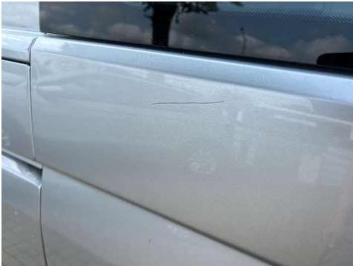
Türe hinten rechts (Delle, Kratzer)
