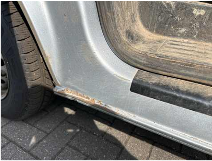
Schweller links (Rost, Lackschaden)
