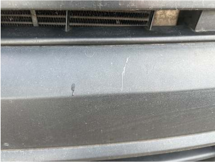
Stoßstange vorne (Kratzer, Verformung)
