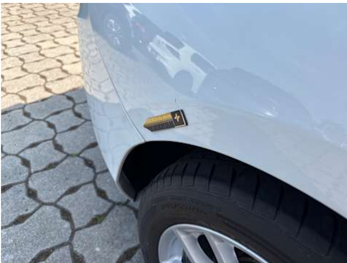
Stoßstange hinten (Spaltmaße ungenau)
