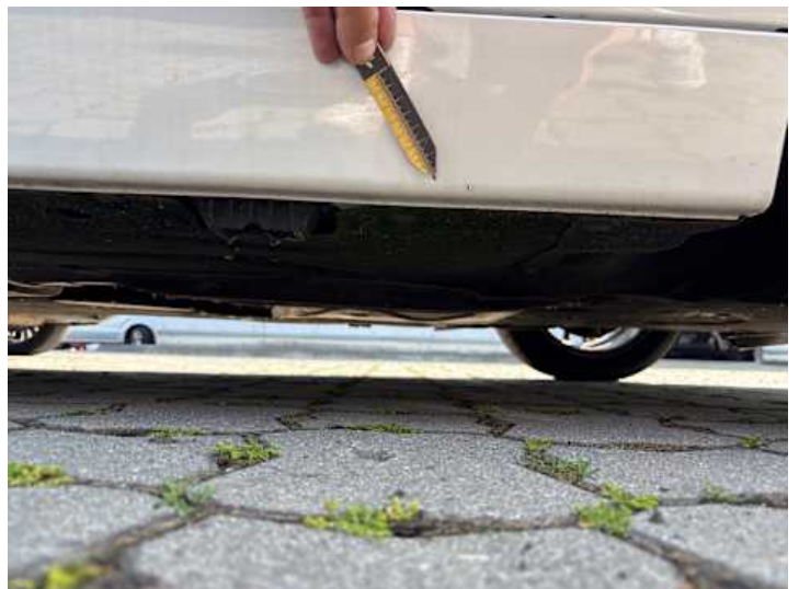
Schweller rechts (Lackschaden)
