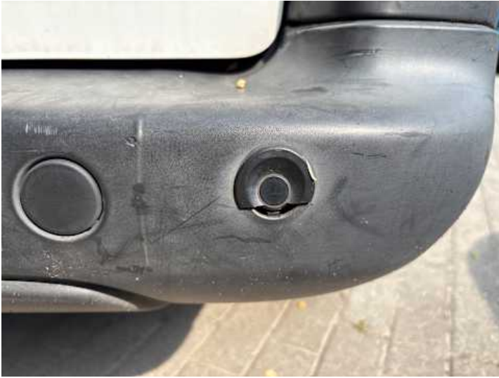
Stoßstange hinten (Verformung, Riss/Bruch)
