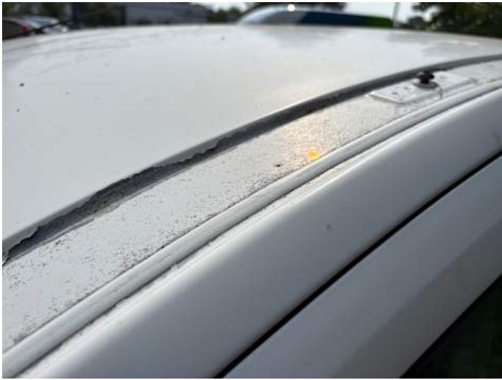
Dach (Lackschaden, Rost)
