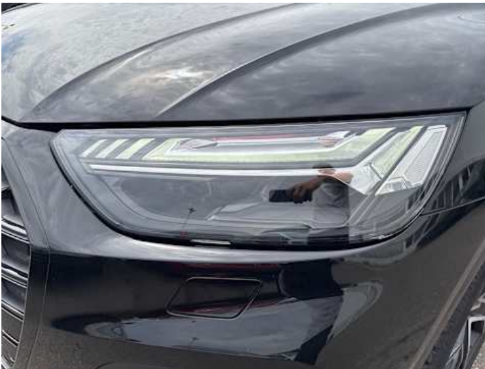
Scheinwerfer (links) (Riss/Bruch)
