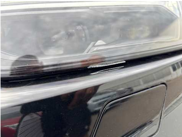
Scheinwerfer (links) (Riss/Bruch)
