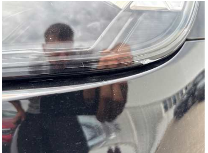
Scheinwerfer (links) (Riss/Bruch)
