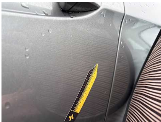
Fahrtür (Kratzer, Verformung)
