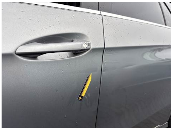
Fahrtür (Kratzer, Verformung)
