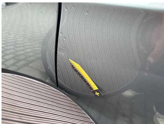
Türe hinten links (Kratzer, Lackschaden, Verformung)
