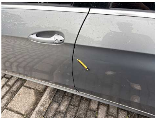
Türe hinten links (Kratzer, Lackschaden, Verformung)
