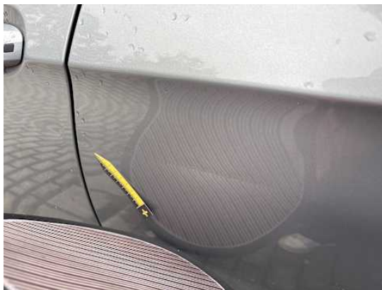
Türe hinten links (Kratzer, Lackschaden, Verformung)
