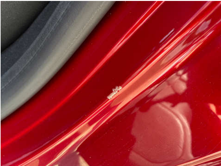
Schweller links (Kratzer, Lackschaden)
