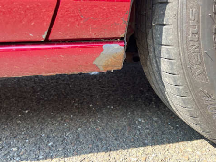
Schweller rechts (Rost, Lackschaden)
