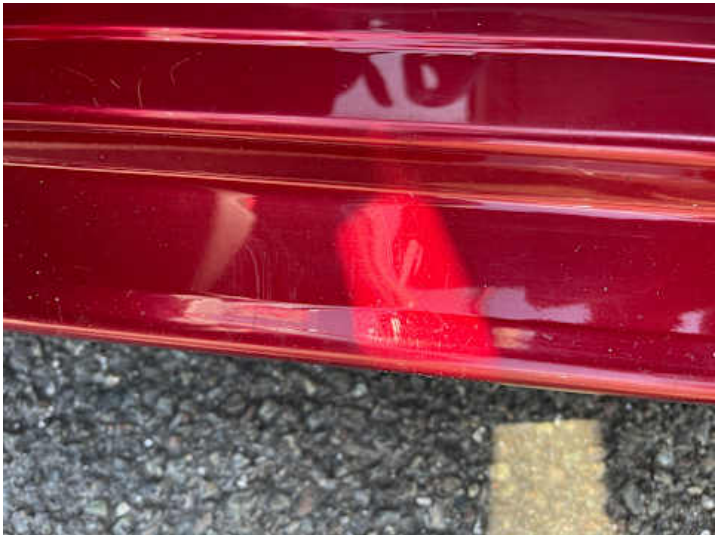
Schweller links (Kratzer, Lackschaden)
