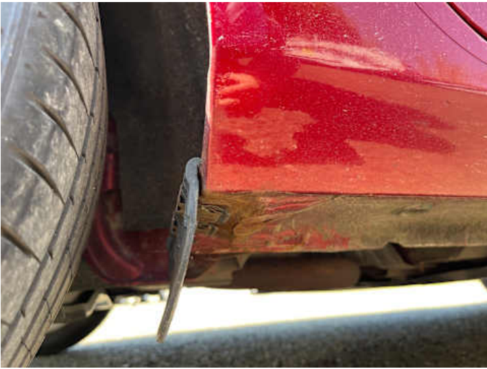
Schweller rechts (Rost, Lackschaden)
