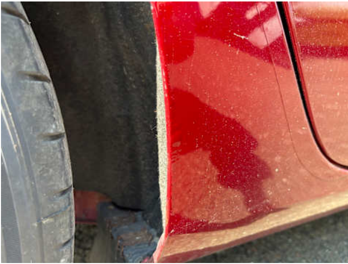
Schweller rechts (Rost, Lackschaden)
