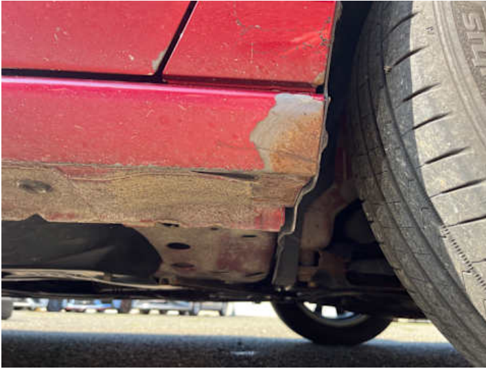
Schweller rechts (Rost, Lackschaden)
