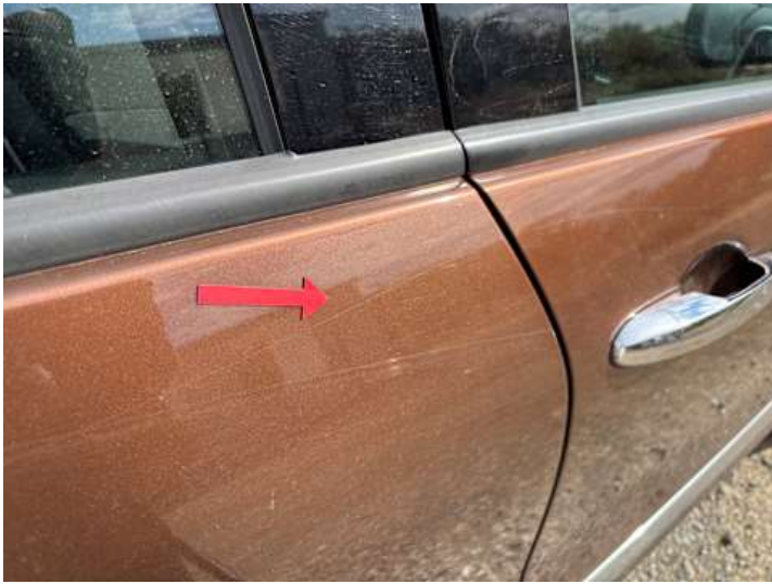
Türe hinten rechts (Kratzer)
