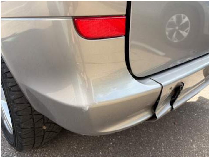
Stoßstange hinten (Spaltmaße ungenau, Riss/Bruch)
