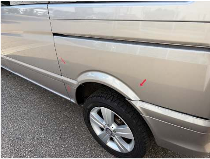
Seitenteil hinten links (Rost, Kratzer)
