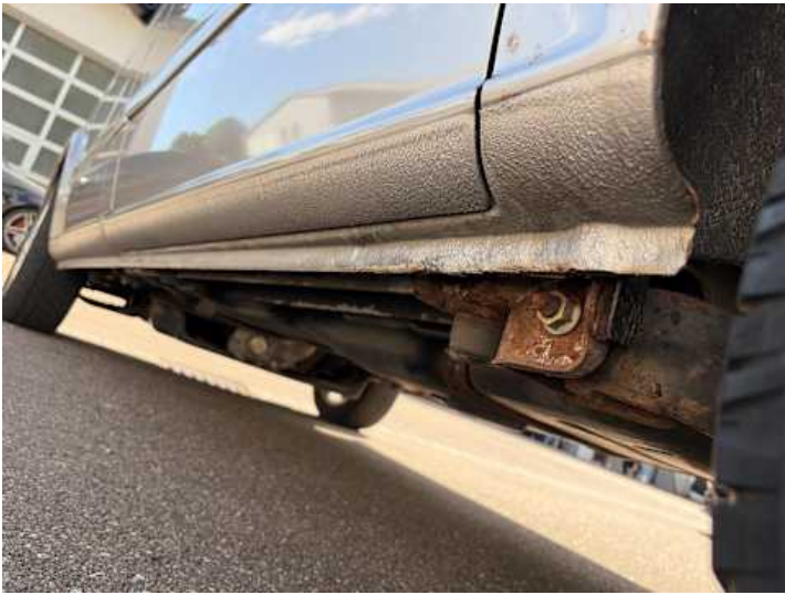
Schweller links (Rost)
