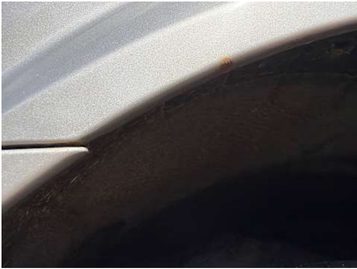
Seitenteil hinten rechts (Kratzer, Delle, Rost)
