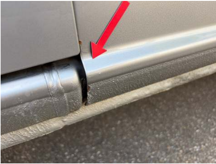
Türe hinten links (Kratzer, Rost)
