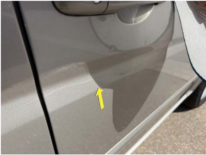
Beifahrtür (Kratzer, Delle)
