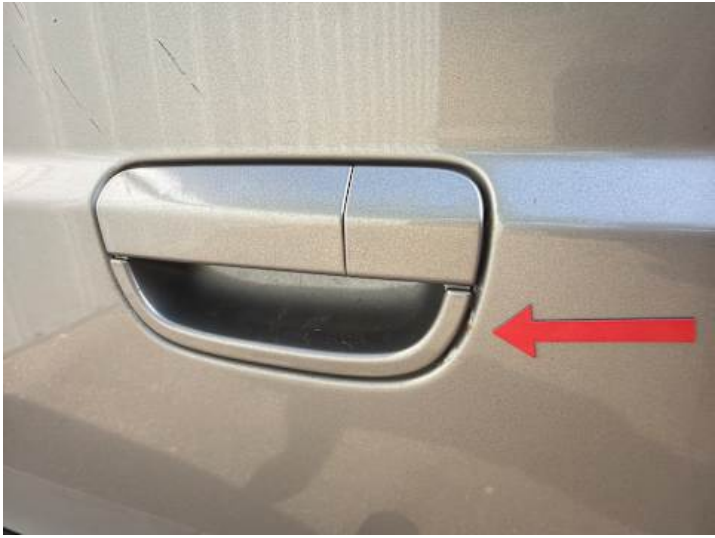
Heckklappe (Rost, Kratzer)
