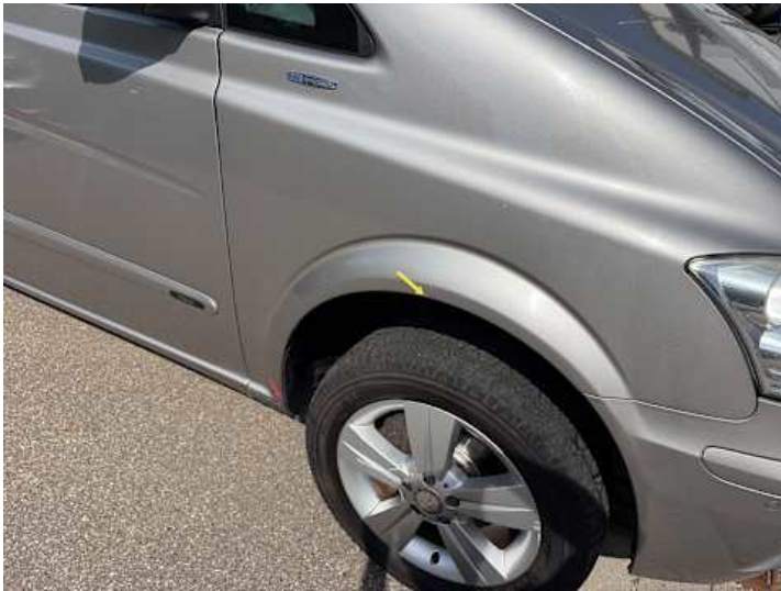
Kotflügel vorne rechts (Rost, Kratzer)
