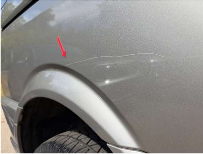
Seitenteil hinten rechts (Kratzer, Delle, Rost)
