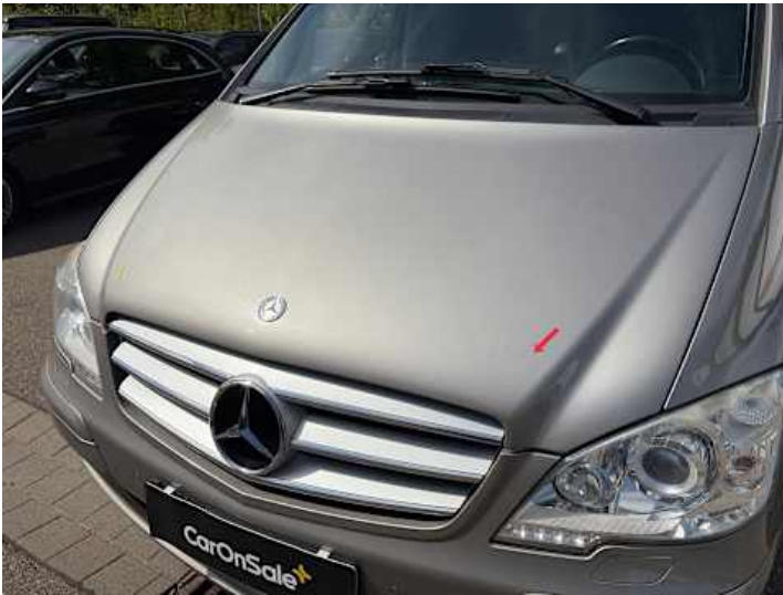
Motorhaube (Steinschlag, Rost)
