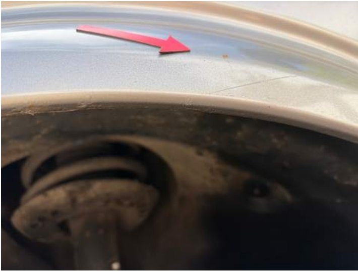
Kotflügel vorne links (Kratzer, Rost)
