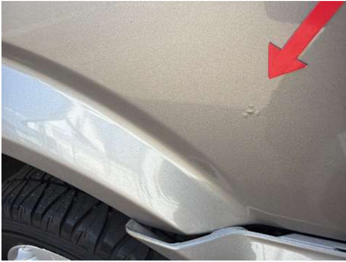
Seitenteil hinten links (Rost, Kratzer)
