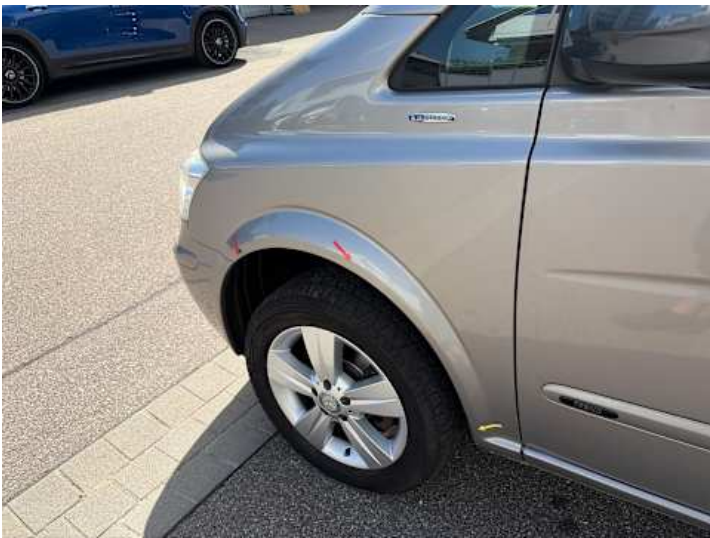
Kotflügel vorne links (Kratzer, Rost)
