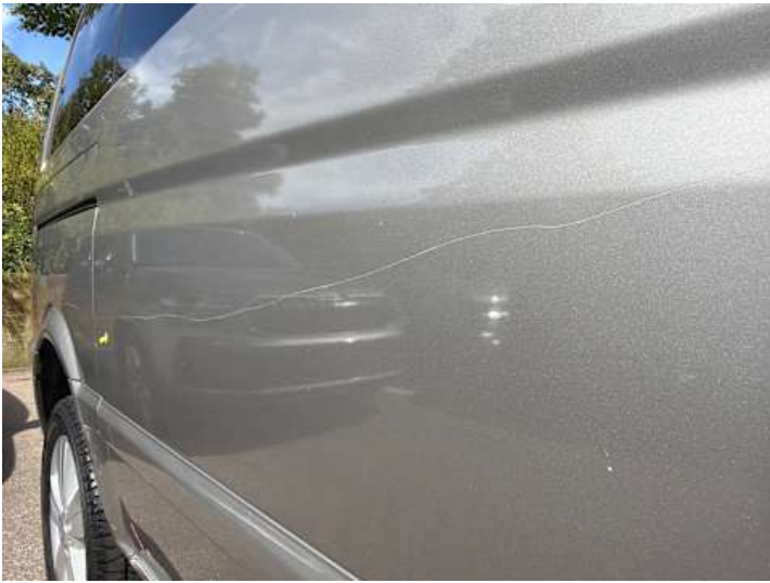
Türe hinten rechts (Rost, Kratzer, Delle)
