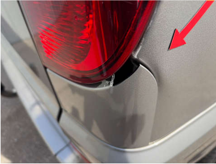
Stoßstange hinten (Spaltmaße ungenau, Riss/Bruch)
