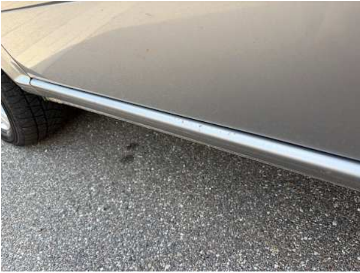
Schweller links (Rost)
