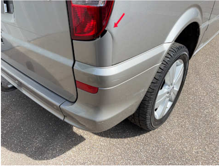
Stoßstange hinten (Spaltmaße ungenau, Riss/Bruch)
