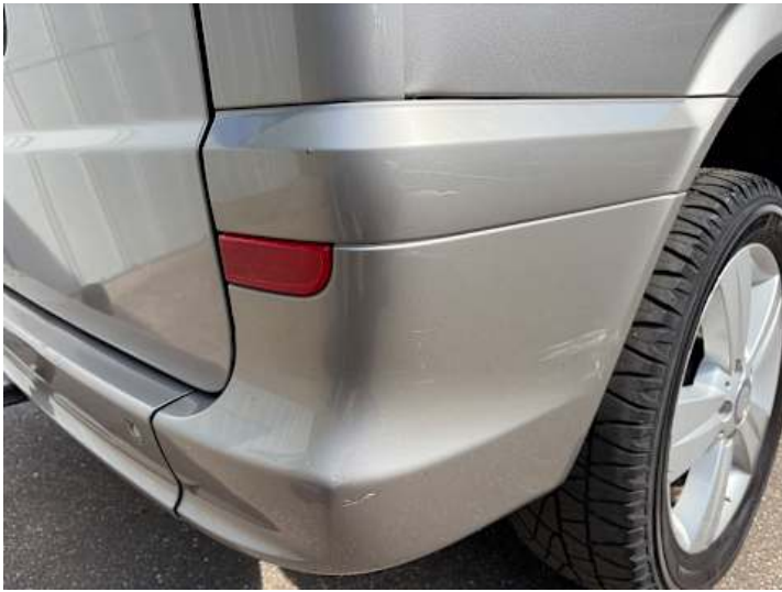
Stoßstange hinten (Spaltmaße ungenau, Riss/Bruch)
