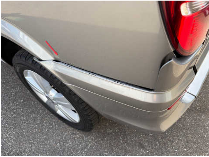
Stoßstange hinten (Spaltmaße ungenau, Riss/Bruch)
