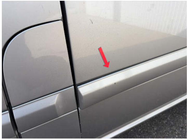
Türe hinten links (Kratzer, Rost)
