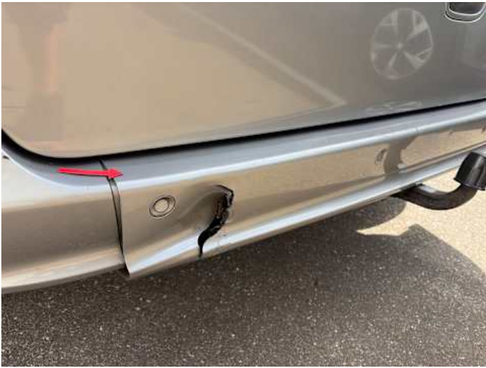
Stoßstange hinten (Spaltmaße ungenau, Riss/Bruch)
