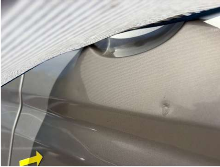
Beifahrtür (Kratzer, Delle)
