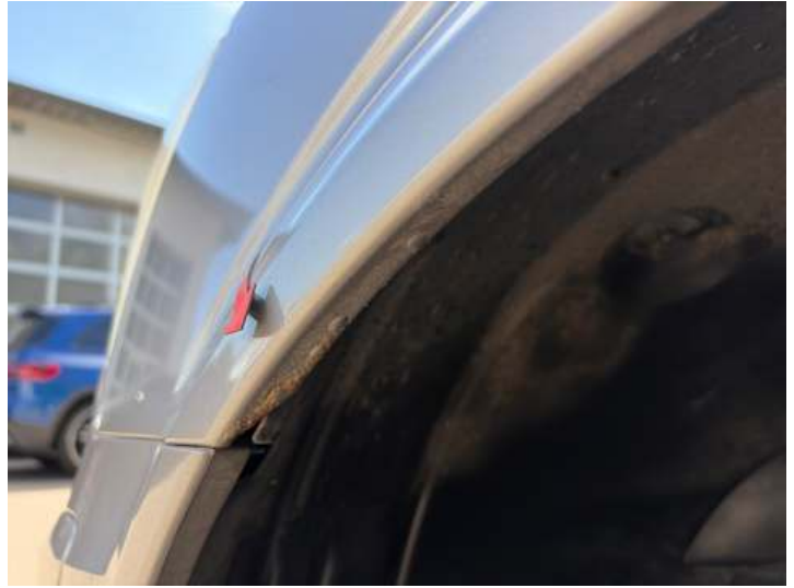
Kotflügel vorne links (Kratzer, Rost)
