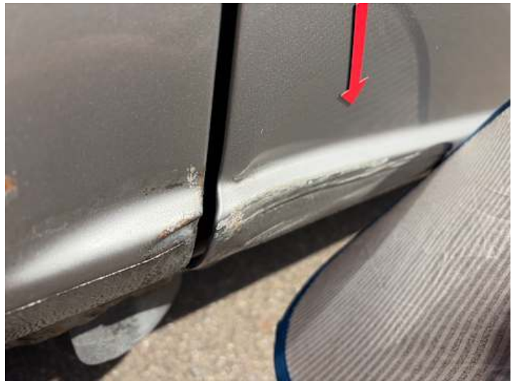
Türe hinten rechts (Rost, Kratzer, Delle)
