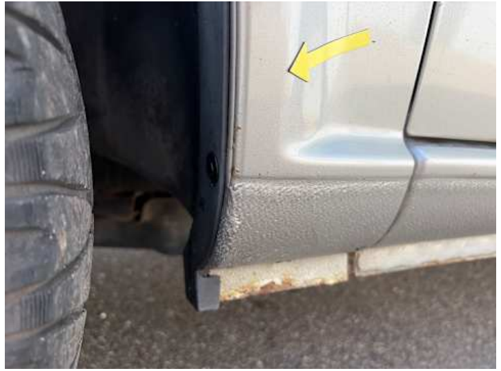
Kotflügel vorne links (Kratzer, Rost)
