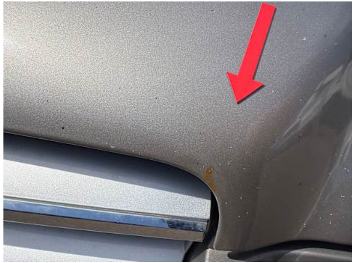
Motorhaube (Steinschlag, Rost)
