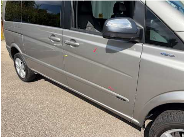
Beifahrtür (Kratzer, Delle)
