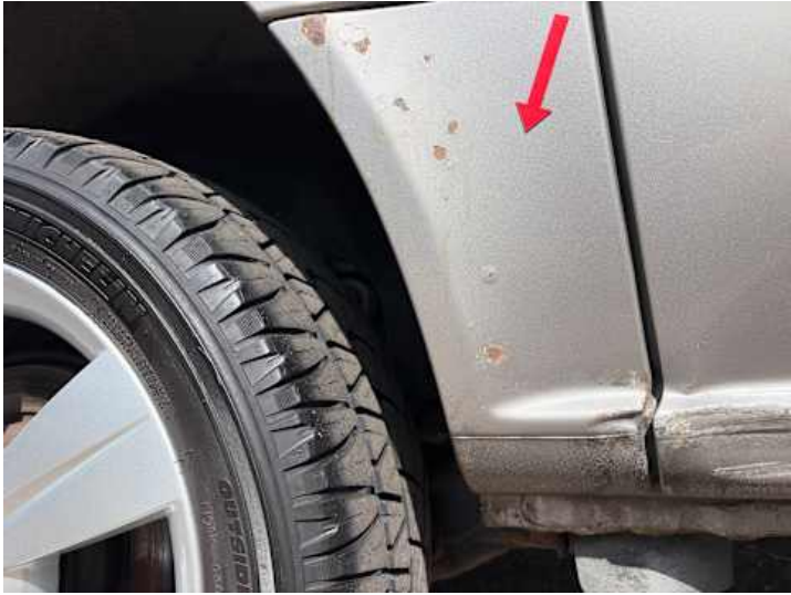
Seitenteil hinten rechts (Kratzer, Delle, Rost)
