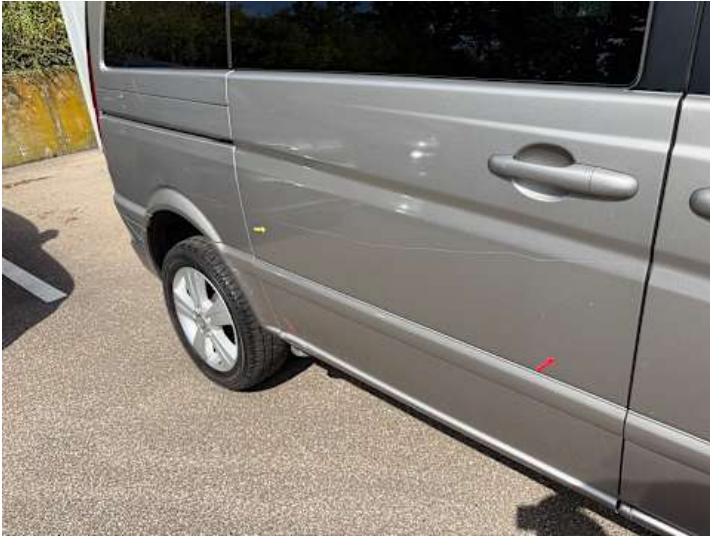
Türe hinten rechts (Rost, Kratzer, Delle)
