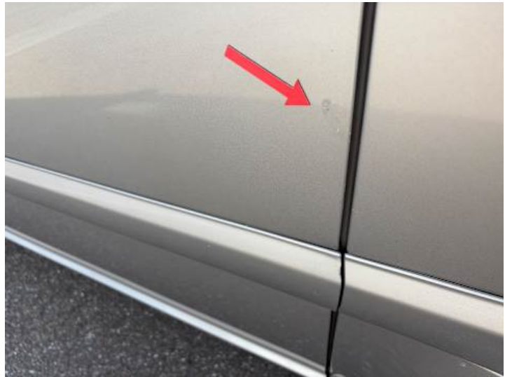
Türe hinten links (Kratzer, Rost)
