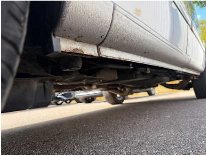
Schweller links (Rost)
