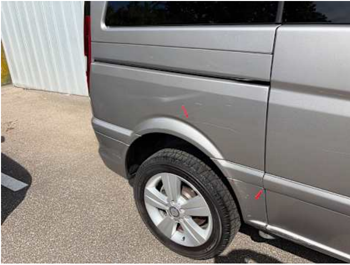
Seitenteil hinten rechts (Kratzer, Delle, Rost)
