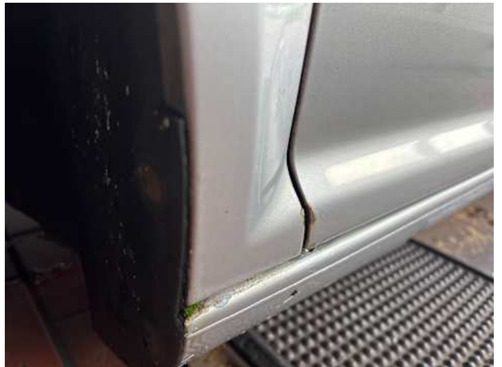
Fahrtür (Kratzer, Rost)
