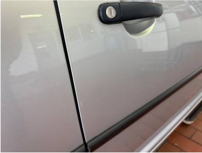
Beifahrtür (Kratzer, Lackschaden)
