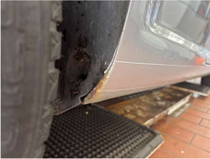
Seitenteil hinten rechts (Rost)
