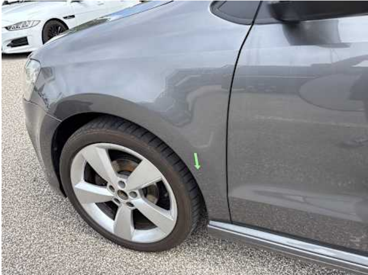
Kotflügel vorne links (Delle, Kratzer)
