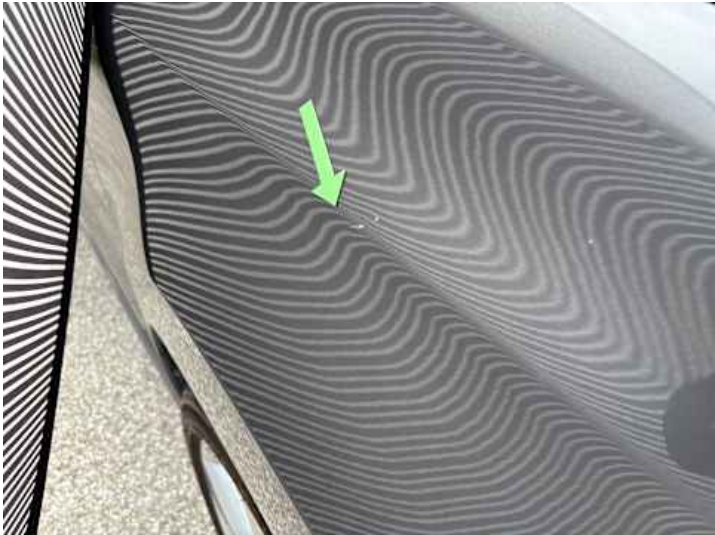
Kotflügel vorne rechts (Delle, Kratzer)
