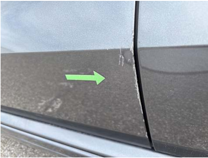
Fahrtür (Delle, Kratzer)
