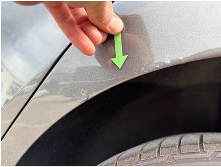
Seitenteil hinten links (Rost)
