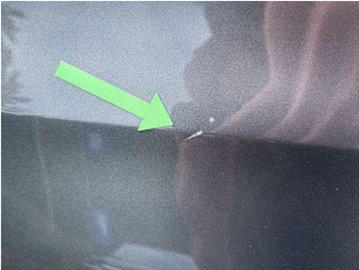
Kotflügel vorne rechts (Delle, Kratzer)
