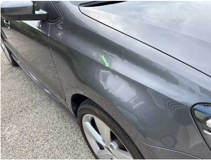
Kotflügel vorne rechts (Delle, Kratzer)
