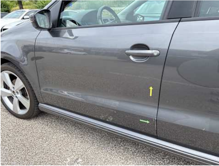
Fahrtür (Delle, Kratzer)
