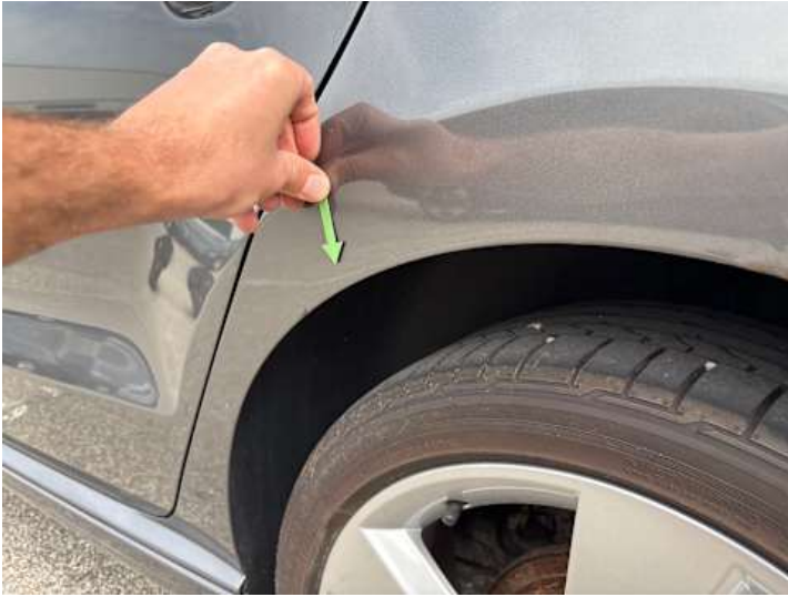
Seitenteil hinten links (Rost)
