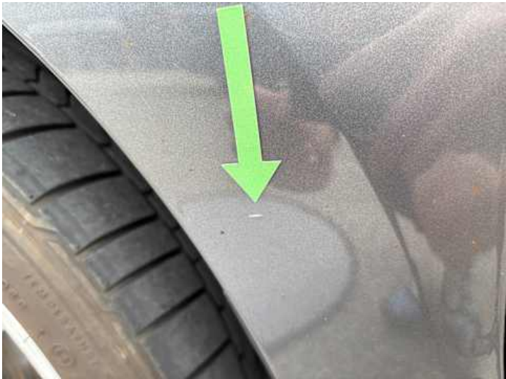
Kotflügel vorne links (Delle, Kratzer)
