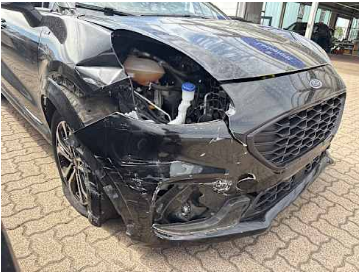
Stoßstange vorne (Riss/Bruch)
