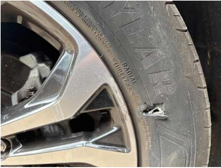
Rad (Ohne Luft, Fremdkörper im Reifen, Kratzer, Kerben)
