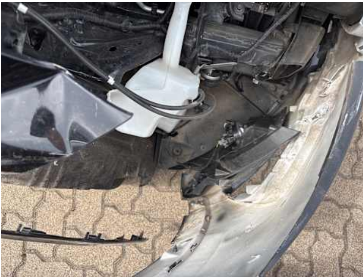
Stoßstange vorne (Riss/Bruch)
