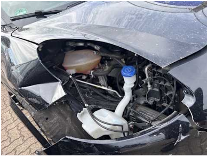
Scheinwerfer (rechts) (Anderer Schaden): Fehlt
