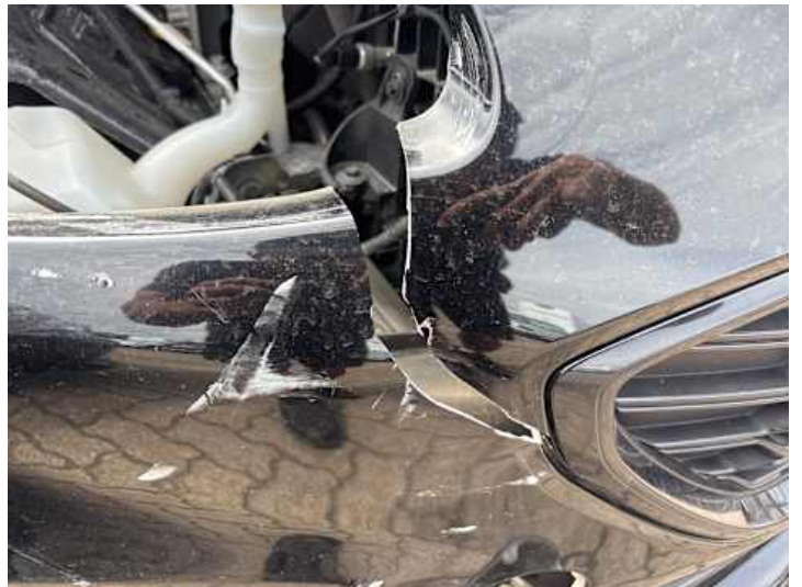
Stoßstange vorne (Riss/Bruch)
