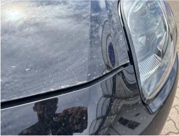
Motorhaube (Spaltmaße ungenau)
