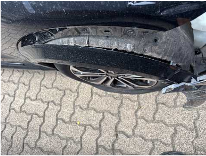
Kotflügel vorne rechts (Verformung, Kratzer, Riss/Bruch)
