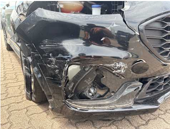
Stoßstange vorne (Riss/Bruch)
