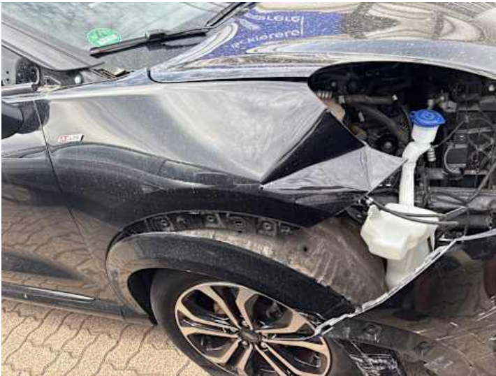
Kotflügel vorne rechts (Verformung, Kratzer, Riss/Bruch)
