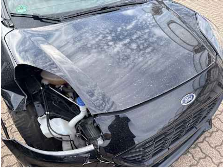
Motorhaube (Spaltmaße ungenau)
