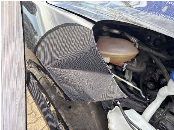
Kotflügel vorne rechts (Verformung, Kratzer, Riss/Bruch)
