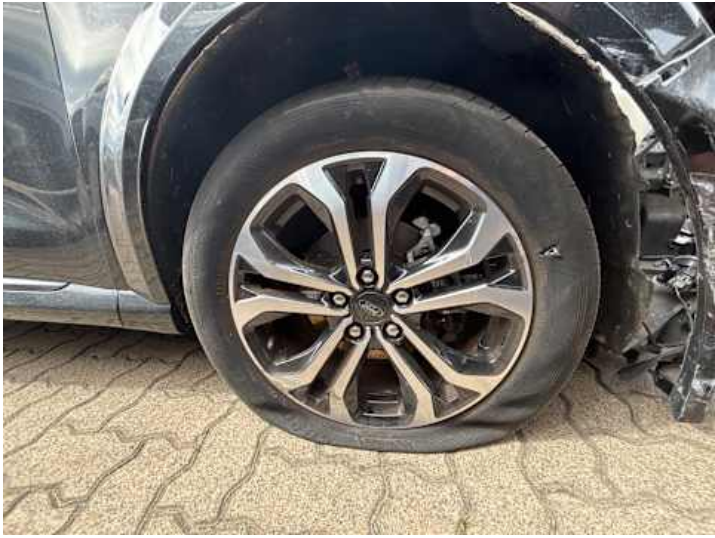
Rad (Ohne Luft, Fremdkörper im Reifen, Kratzer, Kerben)
