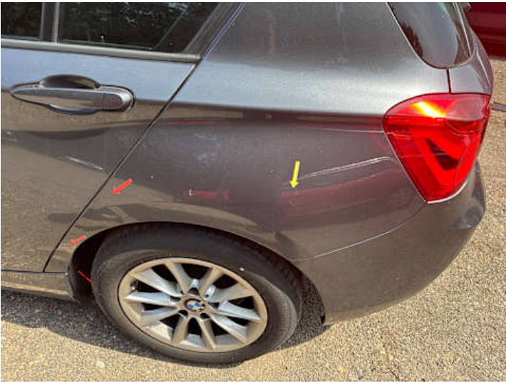
Seitenteil hinten links (Unsachgemäß instand gesetzt, Verformung, Lackschaden)
