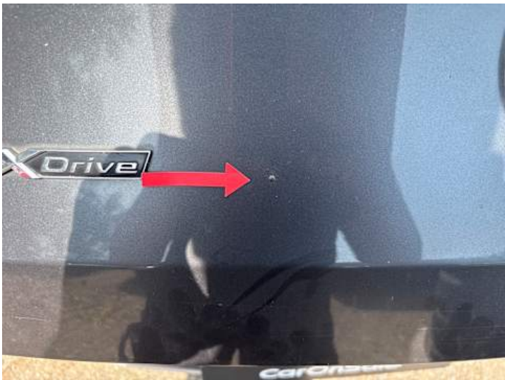
Heckklappe (Rost, Kratzer)
