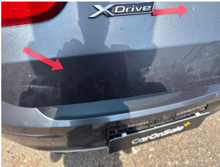
Heckklappe (Rost, Kratzer)
