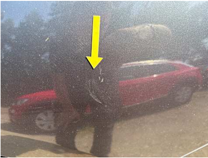
Seitenteil hinten links (Unsachgemäß instand gesetzt, Verformung, Lackschaden)
