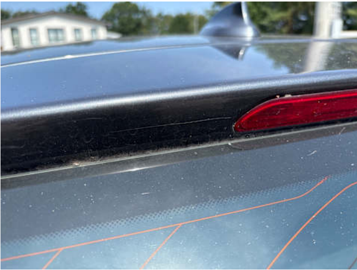
Heckklappe (Rost, Kratzer)
