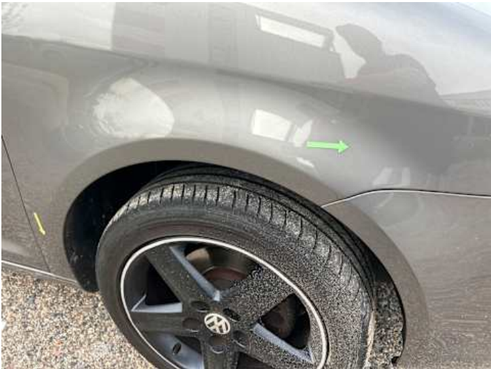
Kotflügel vorne rechts (Kratzer, Verformung)
