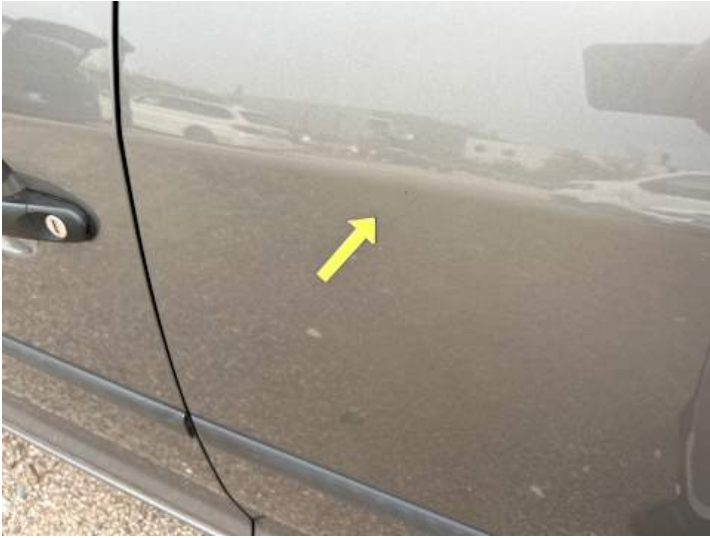
Türe hinten links (Verformung)
