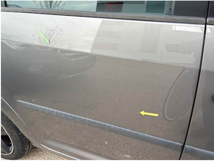
Türe hinten rechts (Kratzer, Delle)
