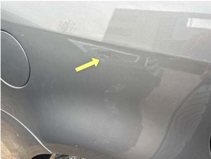
Seitenteil hinten rechts (Kratzer, Delle)
