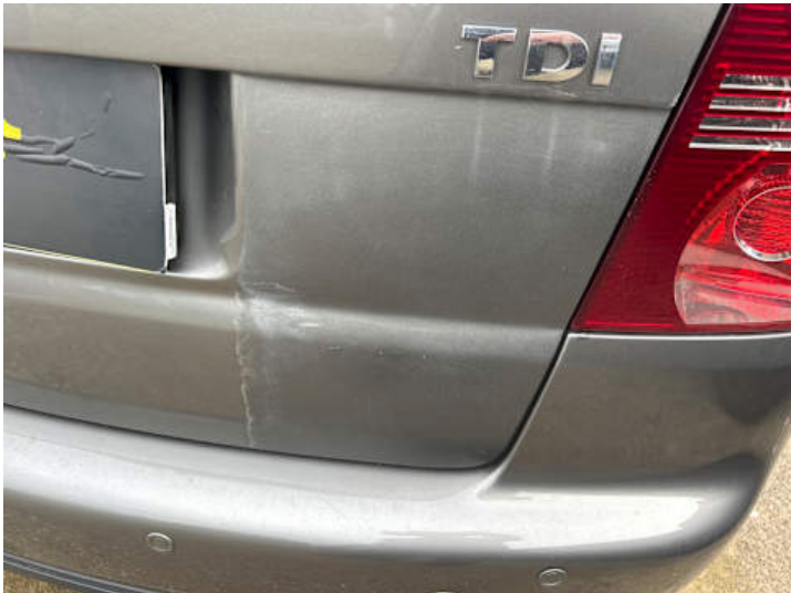
Heckklappe (Unsachgemäß instand gesetzt)
