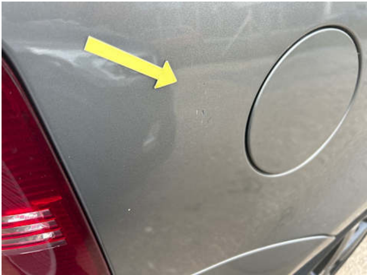
Seitenteil hinten rechts (Kratzer)
