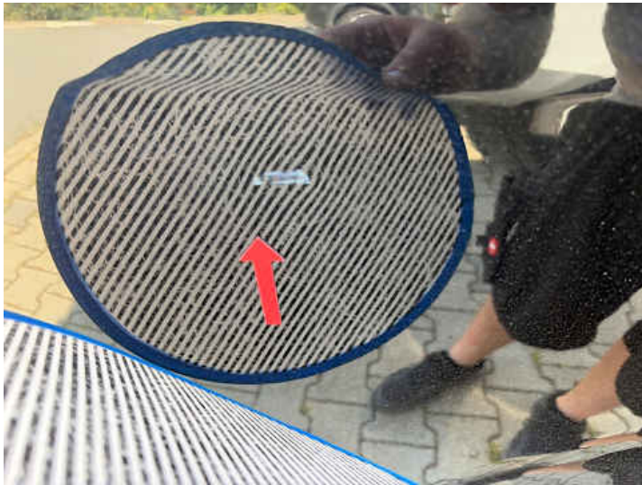
Seitenteil hinten rechts (Delle, Lackschaden)
