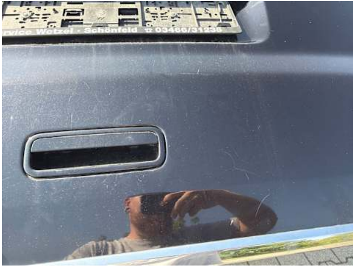
Heckklappe (Kratzer, Lackschaden)
