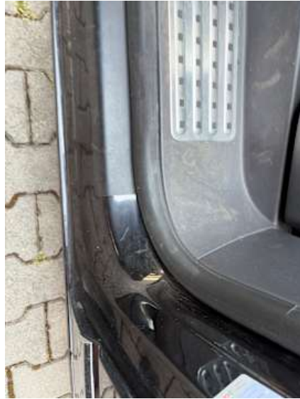
Schweller links (Kratzer)
