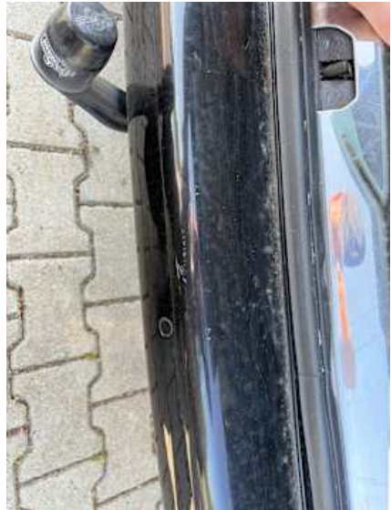
Stoßstange hinten (Kratzer, Lackschaden)
