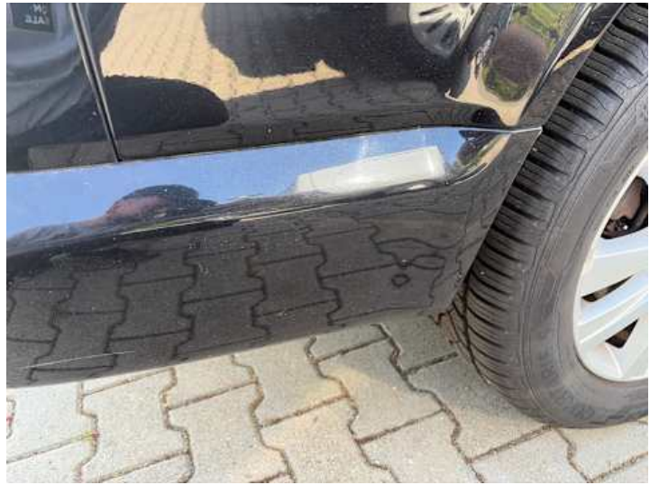
Stoßstange hinten (Kratzer, Steinschlag)
