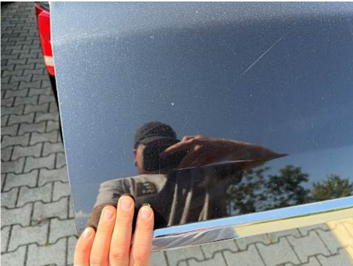
Heckklappe (Kratzer, Lackschaden)
