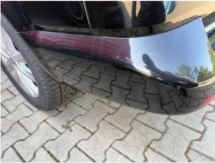
Stoßstange hinten (Kratzer, Steinschlag)
