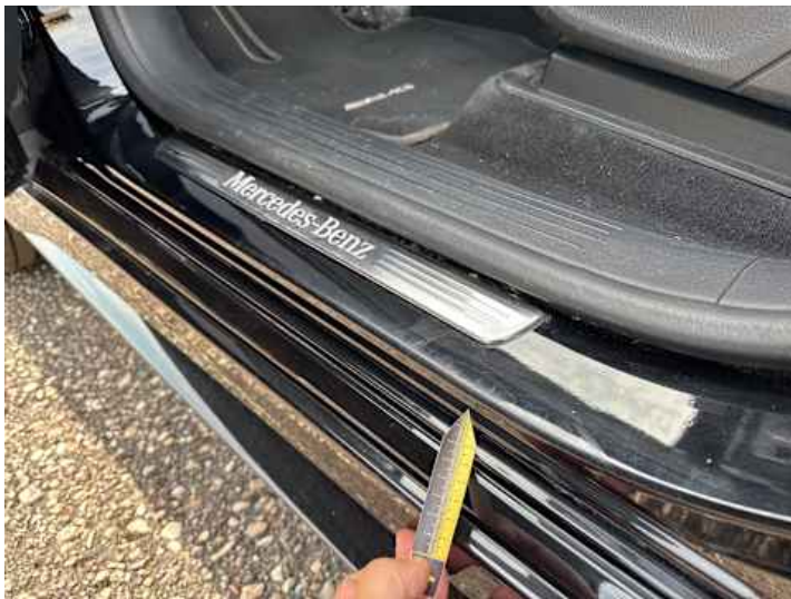
Schweller links (Kratzer)
