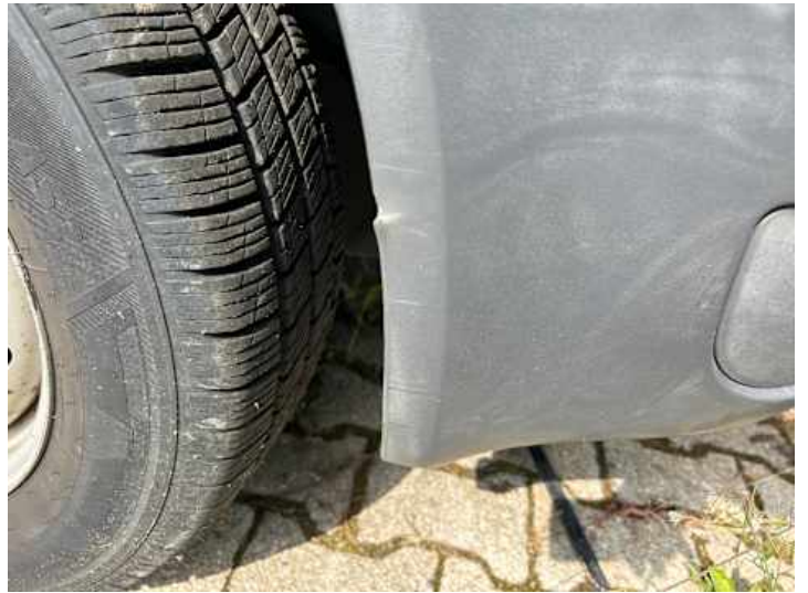
Stoßstange vorne (Verformung)
