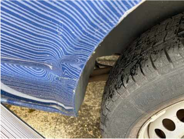
Seitenteil hinten links (Verformung)
