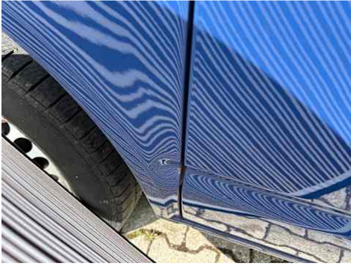
Seitenteil hinten rechts (Verformung)
