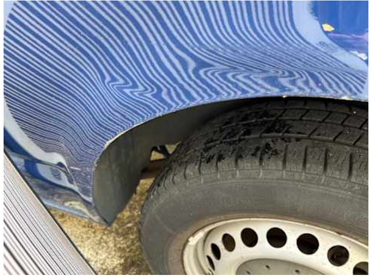
Seitenteil hinten links (Verformung)
