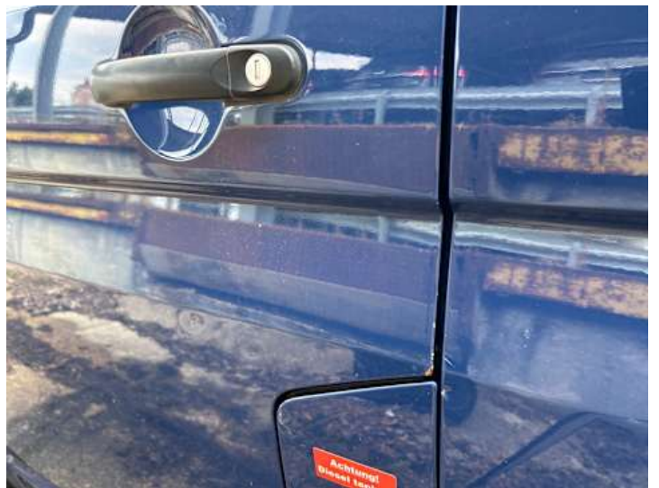
Fahrtür (Kratzer, Rost)
