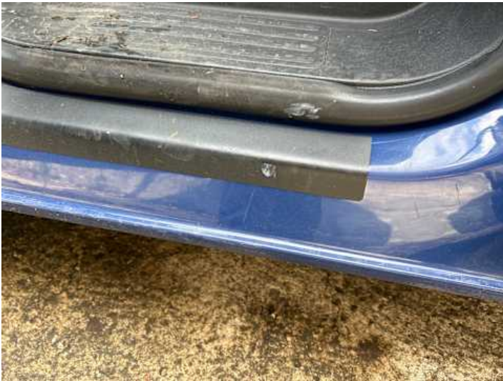
Schweller links (Kratzer)
