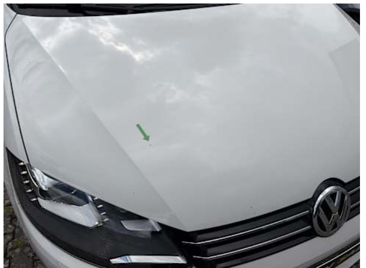
Motorhaube (Rost, Steinschlag)
