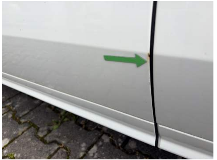
Fahrtür (Rost, Kratzer)
