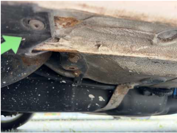
Schweller rechts (Rost)
