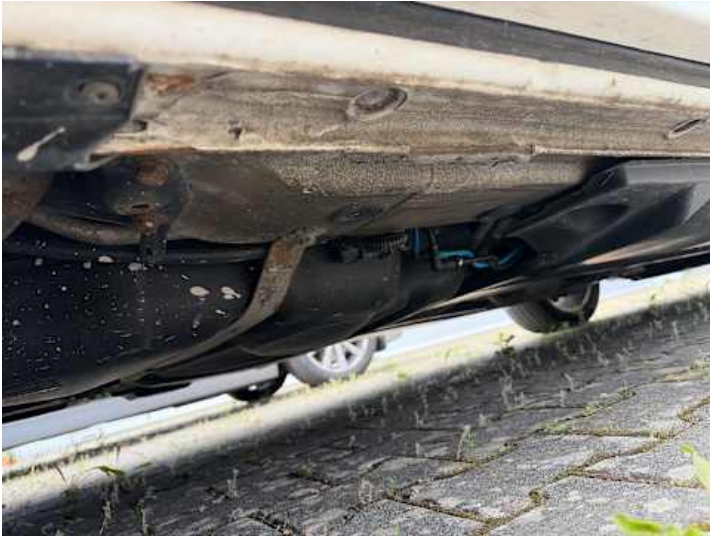
Schweller rechts (Rost)
