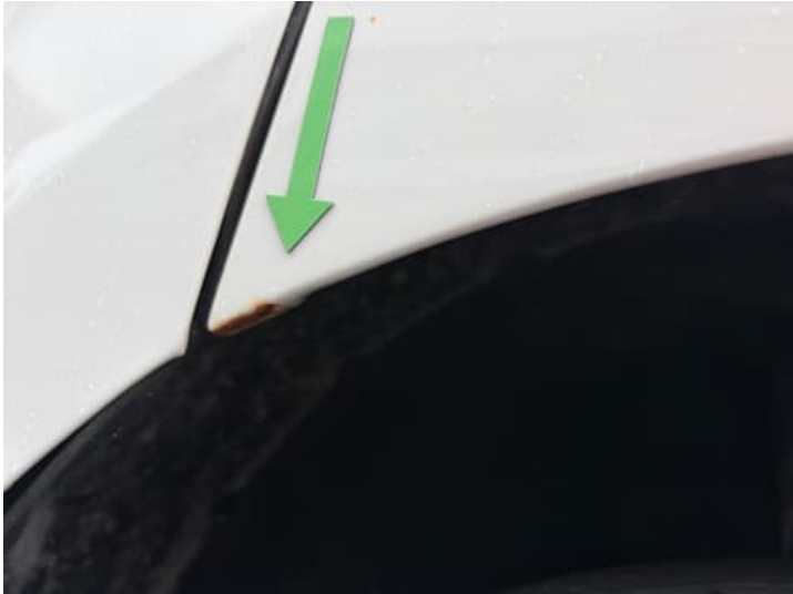
Seitenteil hinten links (Rost)
