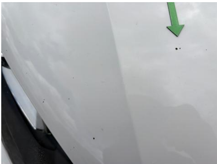
Motorhaube (Rost, Steinschlag)
