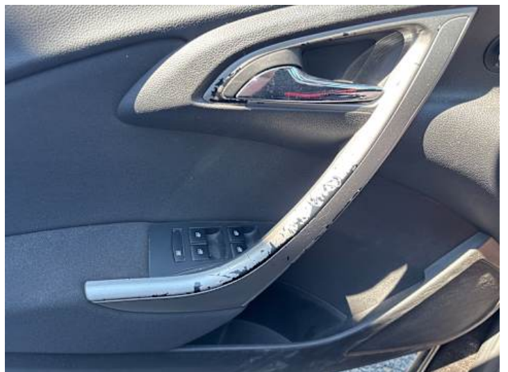
Innenraum (Verschmutzung, Verschleiß)
