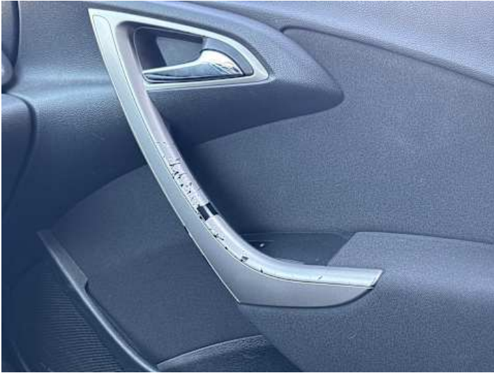
Innenraum (Verschmutzung, Verschleiß)
