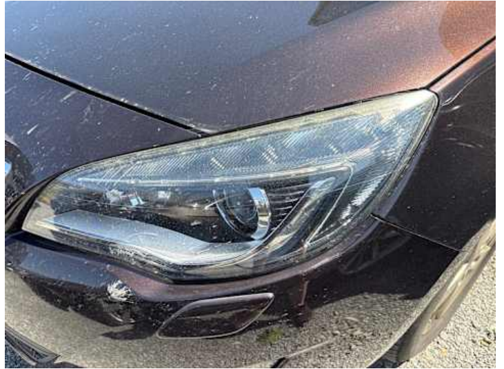
Scheinwerfer (links) (Blind, Anderer Schaden): Rissig
