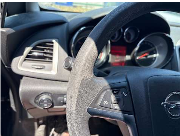
Innenraum (Verschmutzung, Verschleiß)
