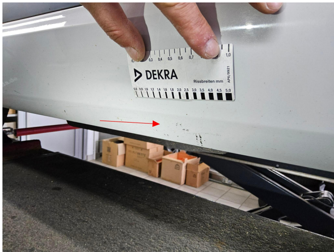
Bild 5: Außen, Tür vorne links - Schutzleiste unten - Lackierung, zer- kratzt, smart repair
