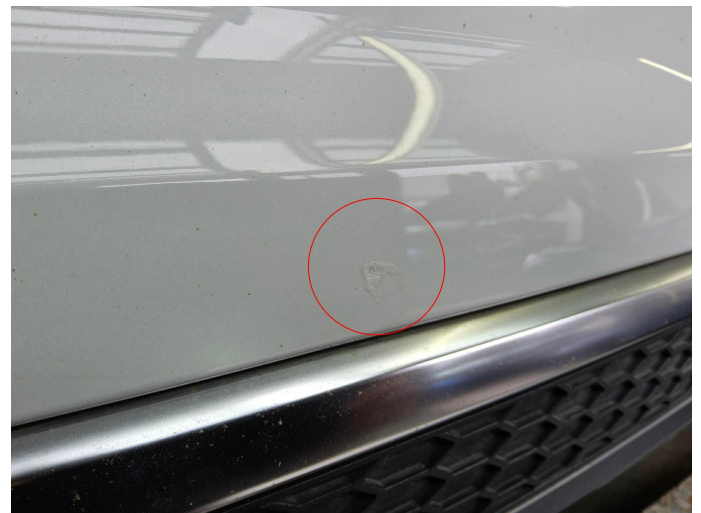
Bild 4: Außen, Stoßfänger hinten - Lackierung, zerkratzt, smart repair
