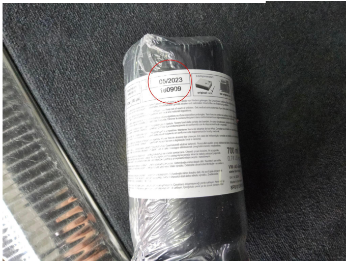
Bild 1: Außen, Reifen Ersatzrad - Füllflasche, überfällig, erneuern
