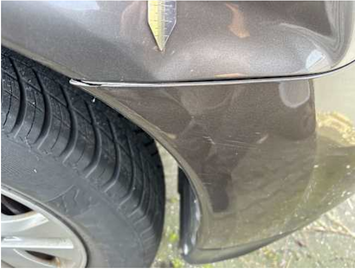
Stoßstange hinten (Kratzer, Riss/Bruch)
