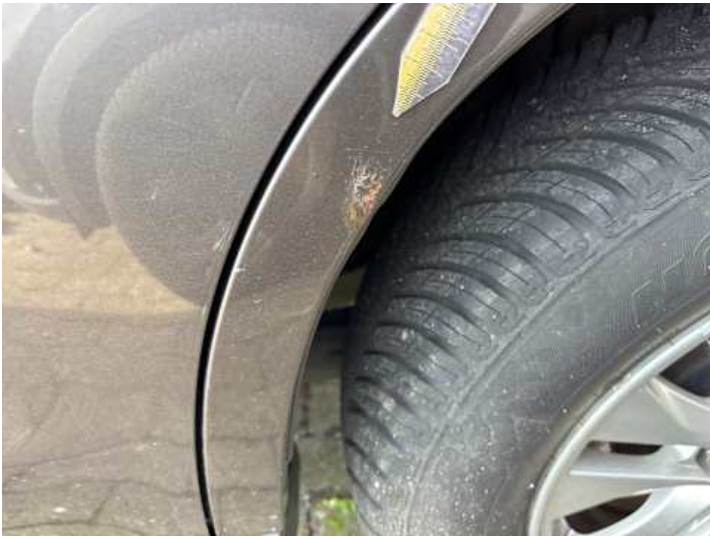
Seitenteil hinten links (Lackschaden, Rost)
