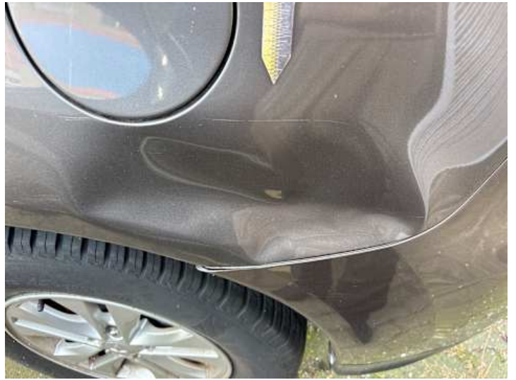
Seitenteil hinten links (Kratzer, Verformung)
