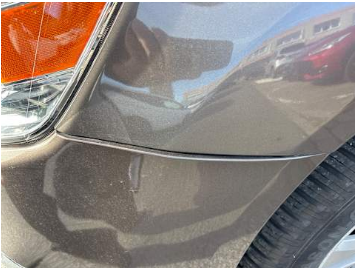
Stoßstange vorne (Spaltmaße ungenau)
